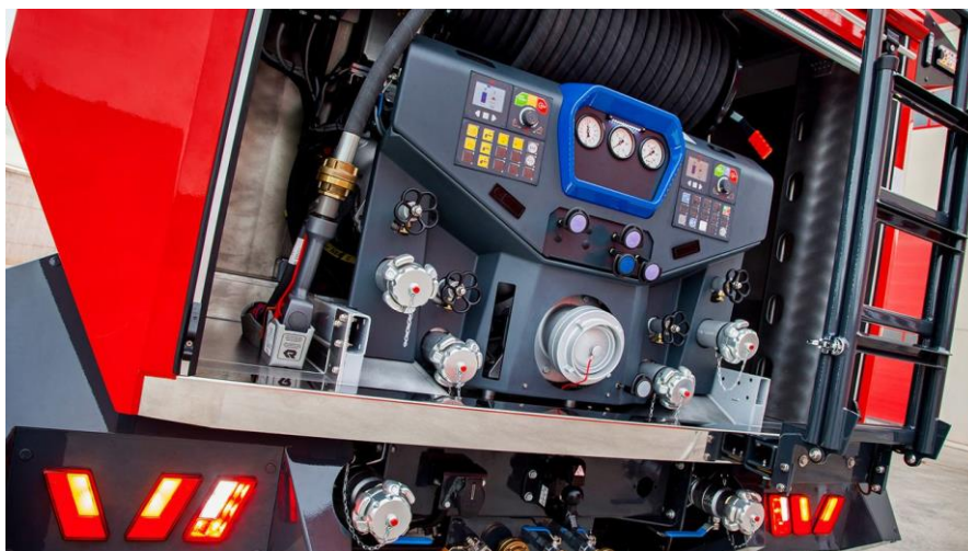
Slika 10. Pumpa ugrađena u vatrogasno vozilo (Izvor: https://www.everythingforthatmoment.com/ ) [19]
