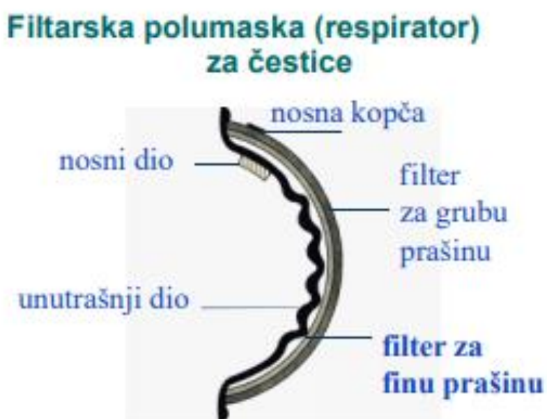
Slika 18. Prikaz višeslojnosti respiratora
