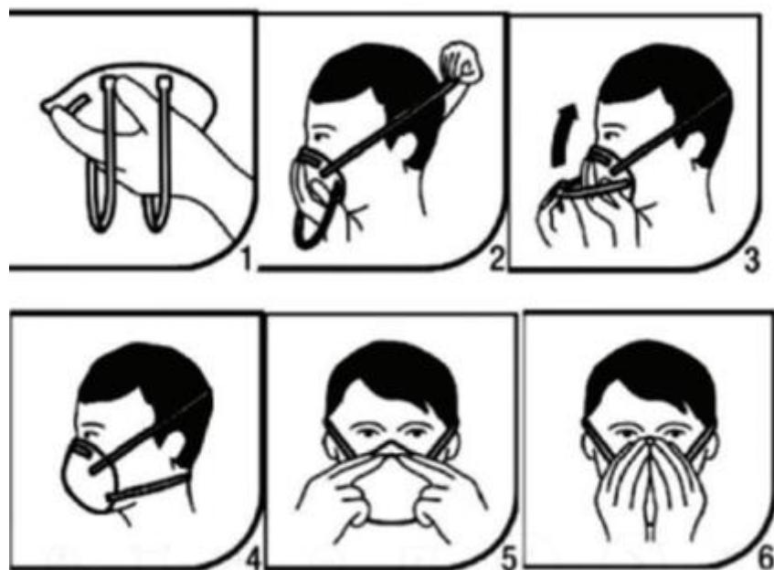
Slika 19. Prikaz pravilnog postavljanja filterske polumaske (respirator)
