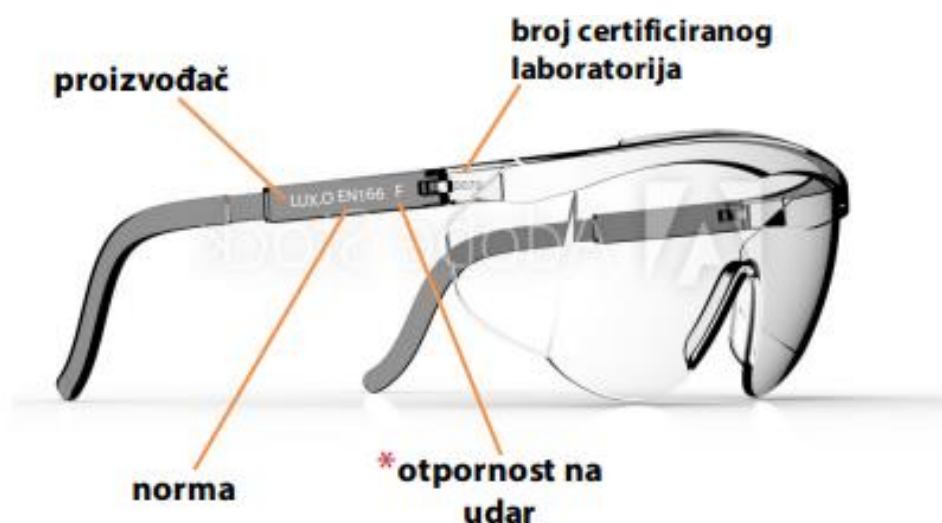
Slika 6. Oznake bočnih štitnika zaštitnih naočala
