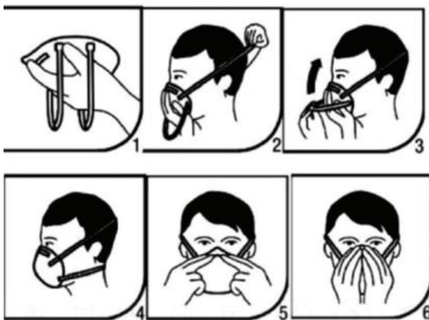
Slika 19. Prikaz pravilnog postavljanja filterske polumaske (respirator)
