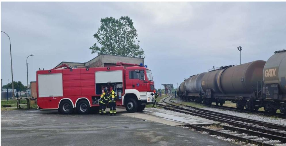
Sl. 10. Navalno vozilo s bacačima voda/pjena i praha za gašenje požara [7]
