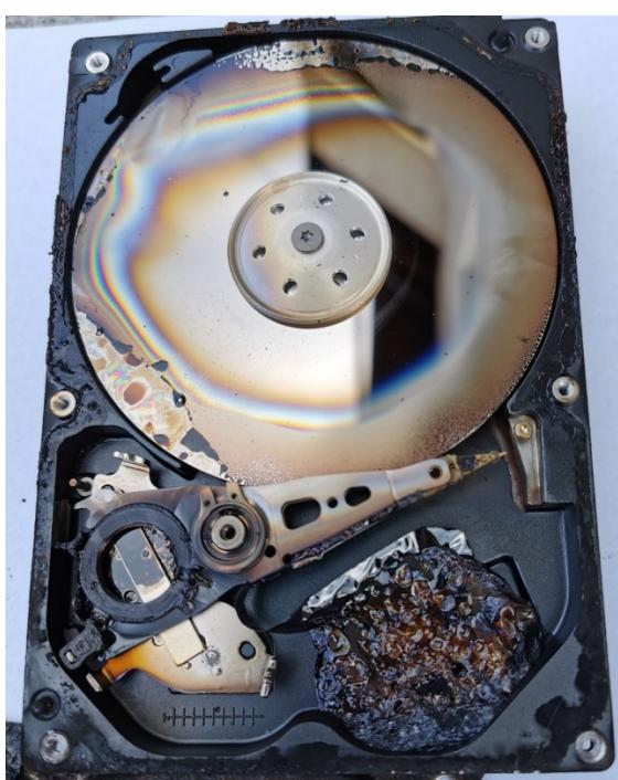
Slika 1. Oštećenje tvrdog diska pod utjecajem visoke temperature [9]
