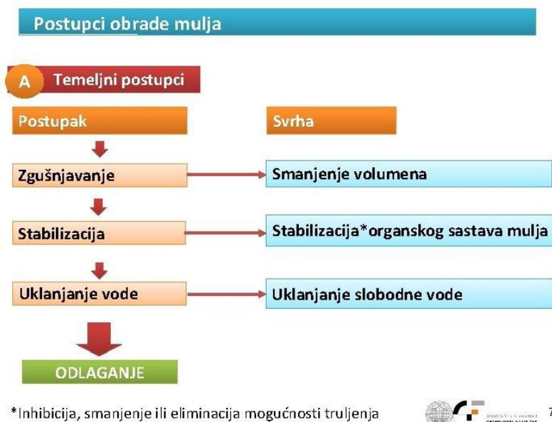
Slika 7. Postupak obrade mulja [9]
