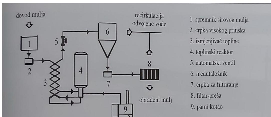
Slika 12. Kondicioniranje zagrijavanjem [8]
