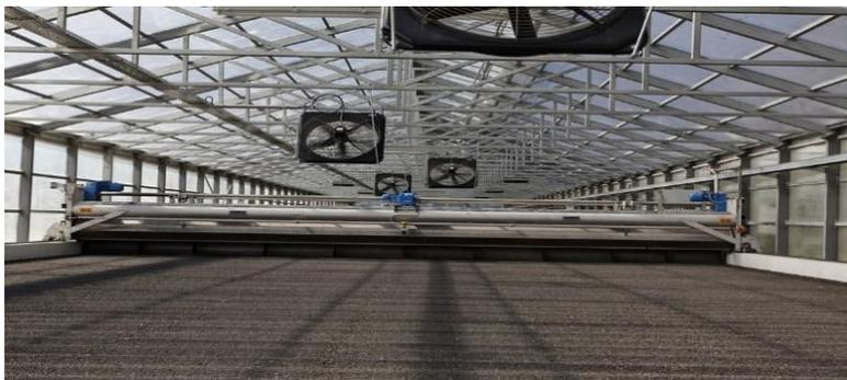
*Slika 13. Solarno sušenje mulja*
