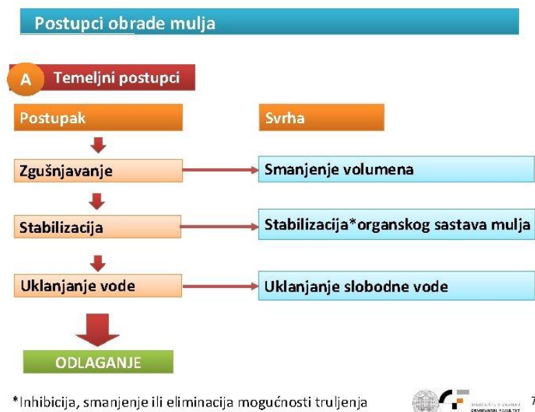
Slika 7. Postupak obrade mulja [9]
