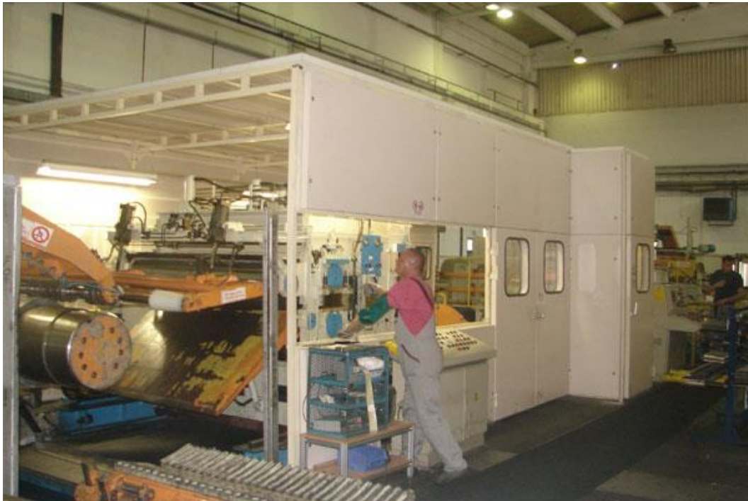
Slika 10. Primjer ograđenog stroja
