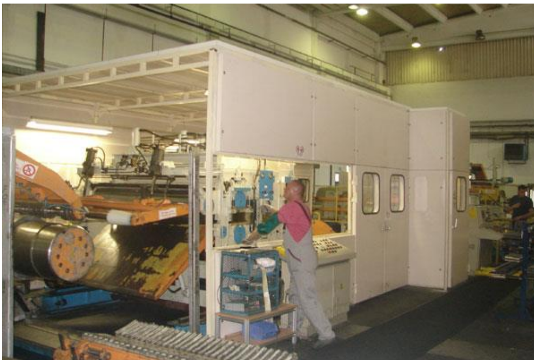
Slika 10. Primjer ograđenog stroja
