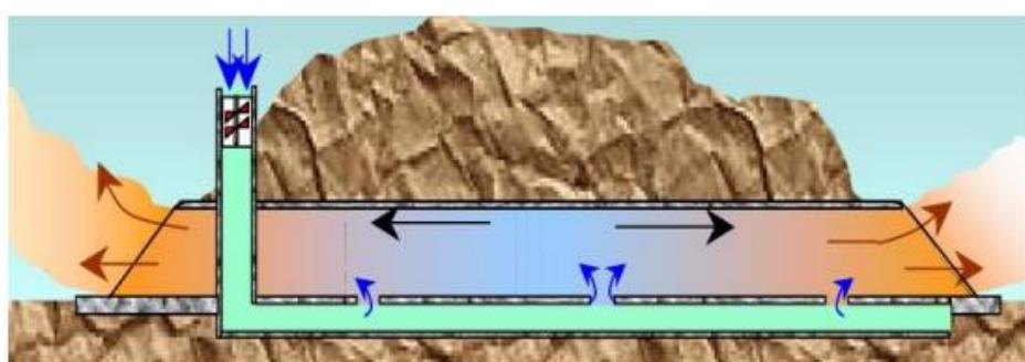
*Slika 7 Polupoprečna ventilacija [6]*
