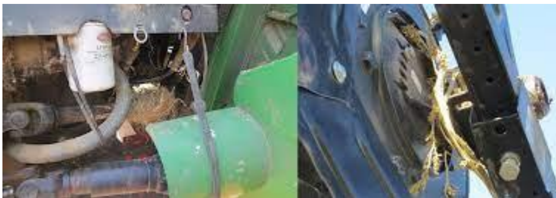
Slika 20.. Zaplitanje oko kardanskog vratila žetvenog uređaja i motovila.,[35]
