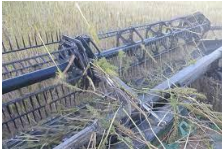
Slika 21.. Prebacivanje stražnje stranice žetvenog uređaja.,[35]
