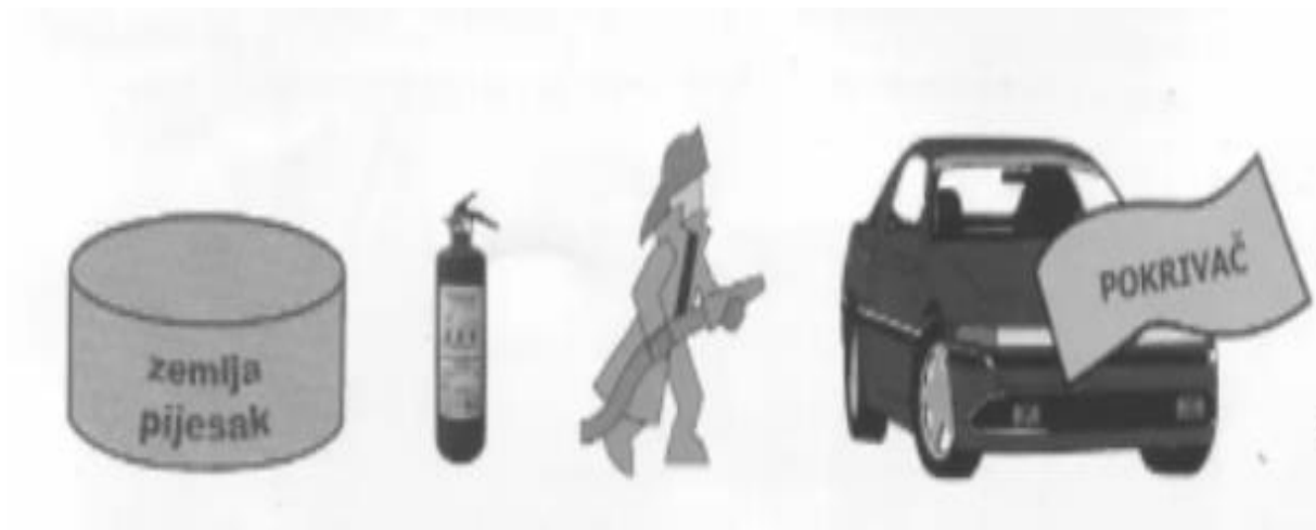
Slika 3. Sredstva za gašenje požara na motornom vozilu [4]
