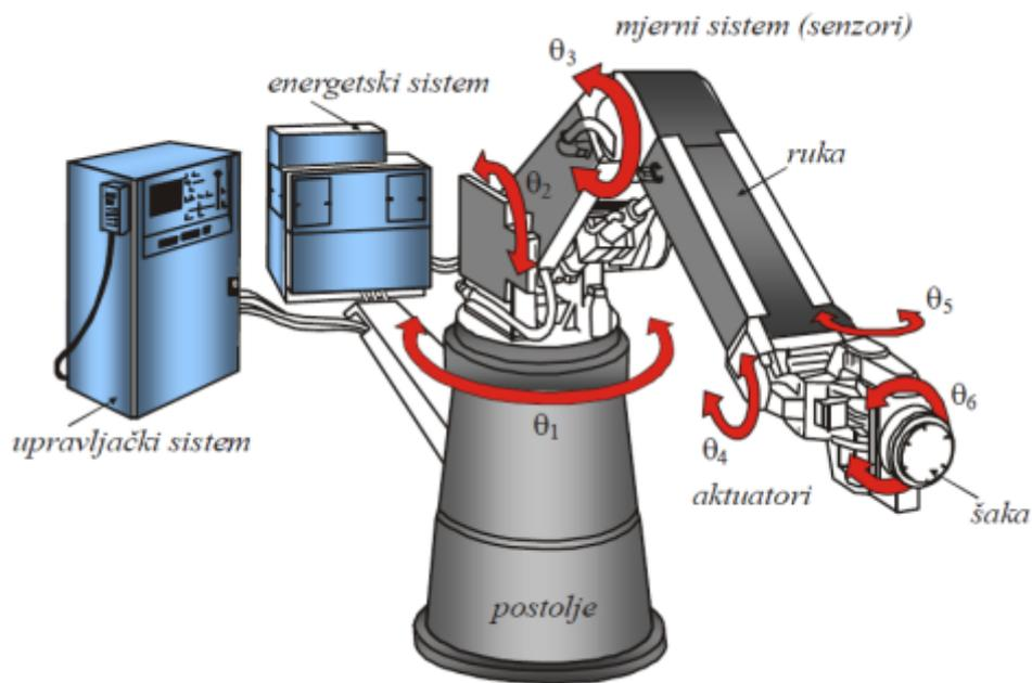
Slika 4. Prikaz industrijskog robota s osnovnim dijelovima [5]
