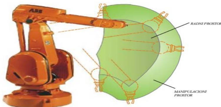
Slika 16. Radni i manipulacijski prostor robota [5]
