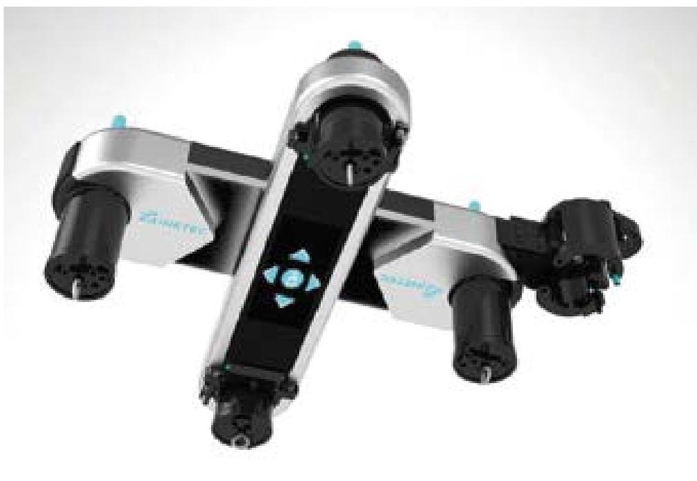
Slika 24. Robot za ispitivanje cijevi [21]
