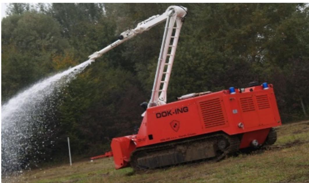
Slika 14. Višenamjenski robotizirani protupožarni sustav MVF-5 [14]
