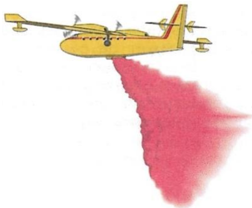
Slika 26. Izbacivanje retardanata iz kanadera [11]
