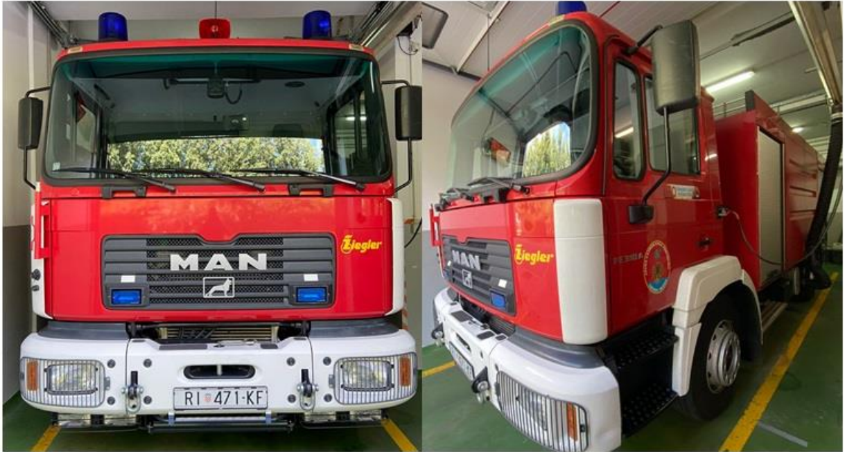
Slika 35. Vatrogasna autocisterna marke „MAN“ s 8000 litara vode u spremniku (Izvor: Autor rada)
