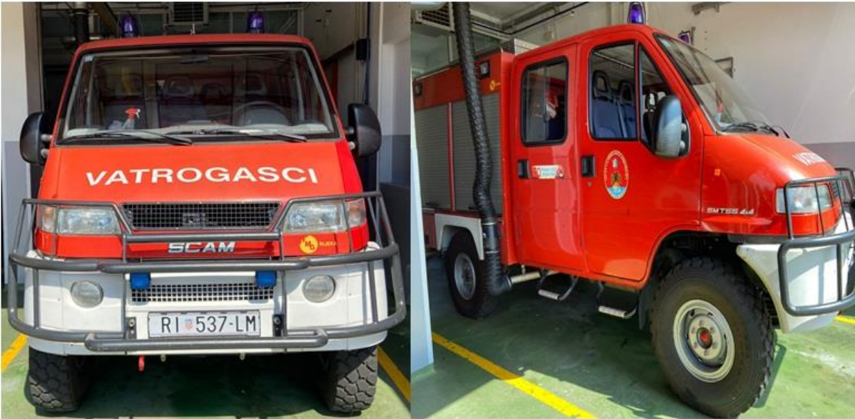
Slika 36. Šumsko vatrogasno vozilo marke "SCAM" s 1000 litara vode u spremniku (Izvor: Autor rada)
