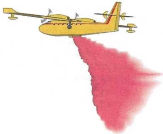
Slika 26. Izbacivanje retardanata iz kanadera [11]
