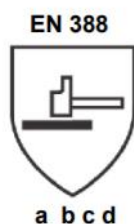
Slika 10. Primjer označavanja rukavica za zaštitu od mehaničkih opasnosti [13]
