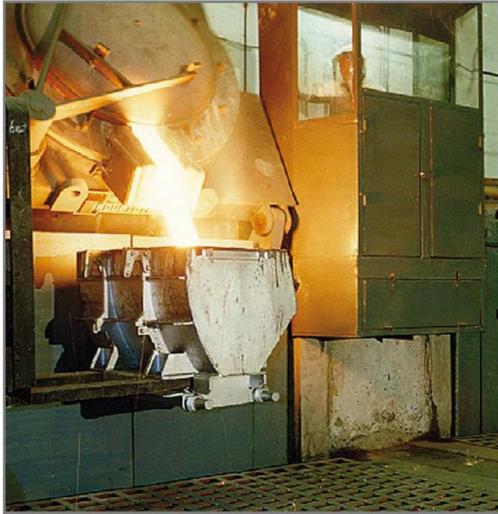
Ovaj radnik u talionici zaštićen je na sva tri ključna načina: udaljenošću, barijerom i osobnom zaštitnom opremom (PPE)
