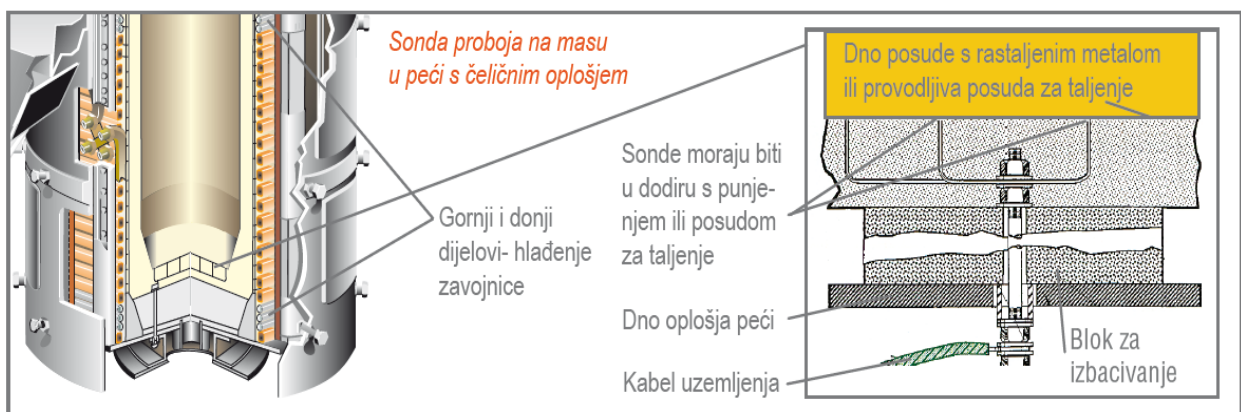
Slika 17. Sonda proboja na masu sa čeličnim oplošjem
