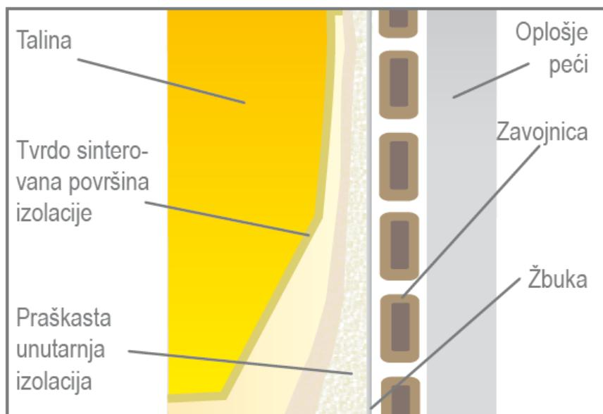
Slika 21. Presjek peći sa prikazom vatrostalne obloge
