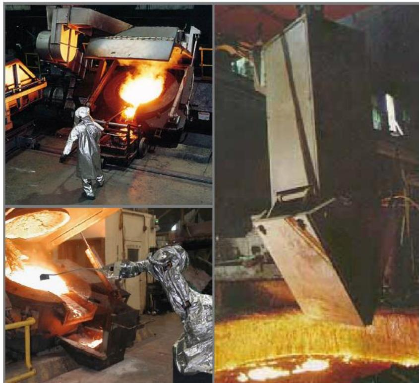
*Fotografije prikazuju tri različite metode uklanjanja šljake koje ljevaonice mogu koristiti: sposobljeni i kvalificirani radnik ljevaonice koji nosi prikladnu osobnu zaštitnu opremu (PPE), automatizirani sustav ARMS™ ili automatizirana školjkasta grabilica za šljaku.*
