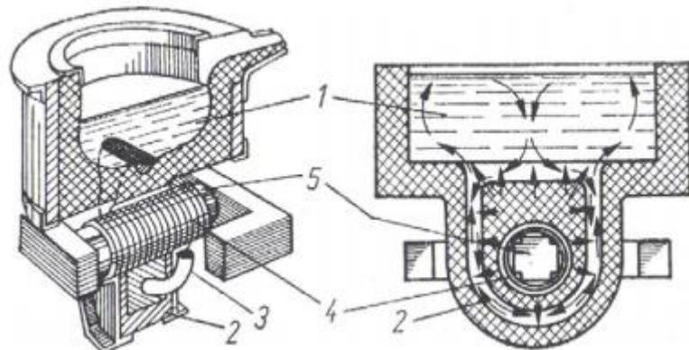
Slika 10. Indukcijska peć
