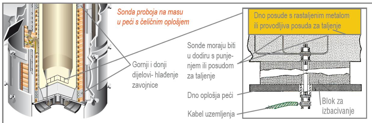
Slika 17. Sonda probaja na masu sa čeličnim oplošjem
