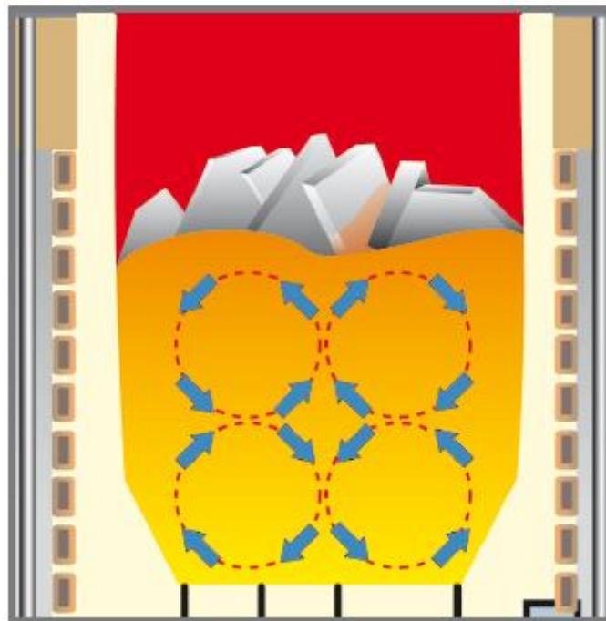
Slika 5. Indukcijsko mješanje unutar peći
