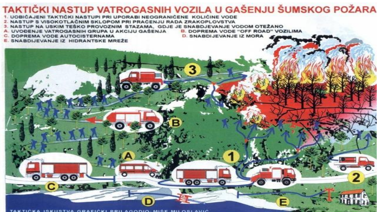
Slika 7. Taktički nastup vatrogasnih vozila
