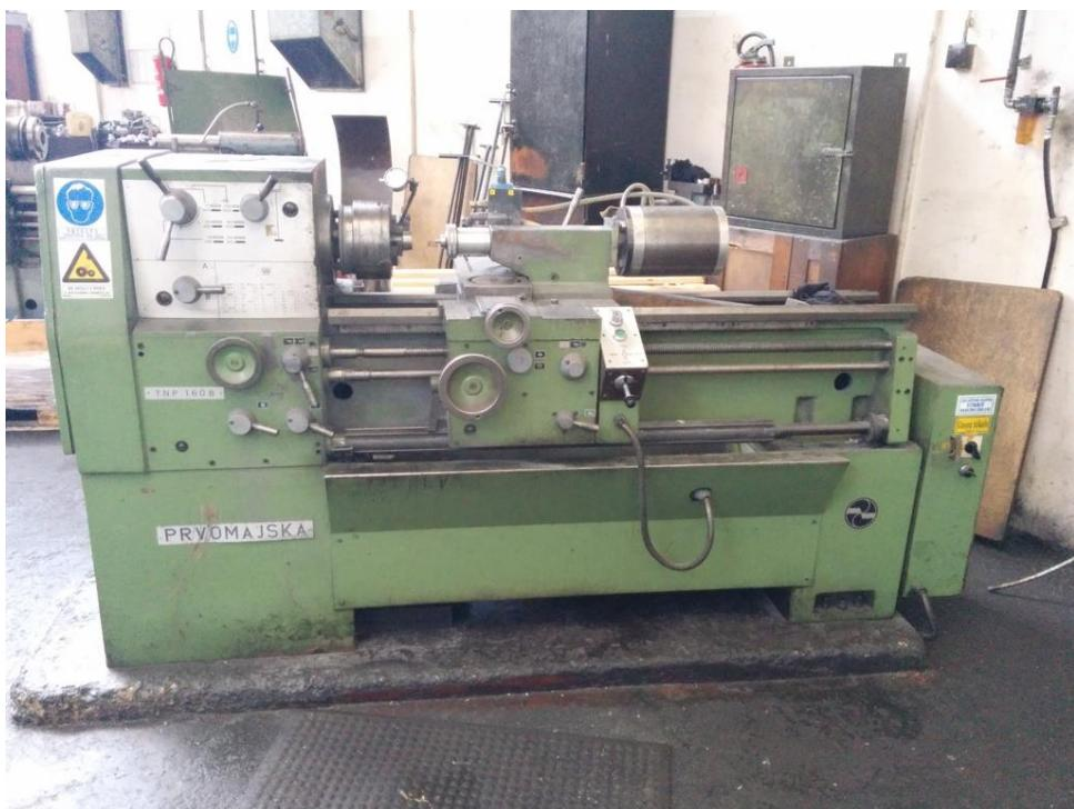
Slika 10. Klasični tokarski stroj
