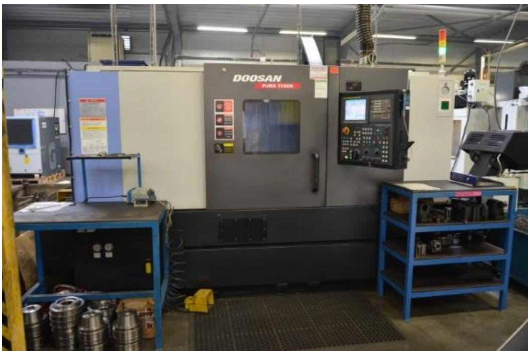
Slika 11. CNC tokarski stroj DOOSAN PUMA
