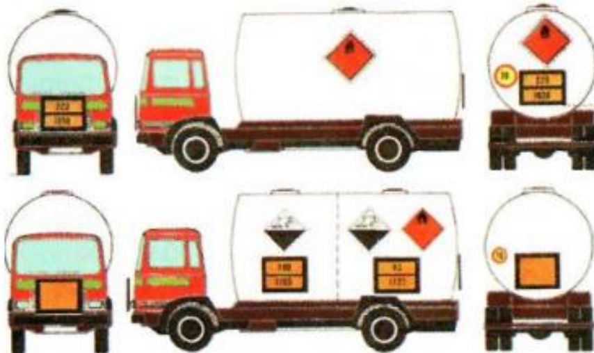
Slika 13. Označavanje vozila listicama opasnosti [2]
