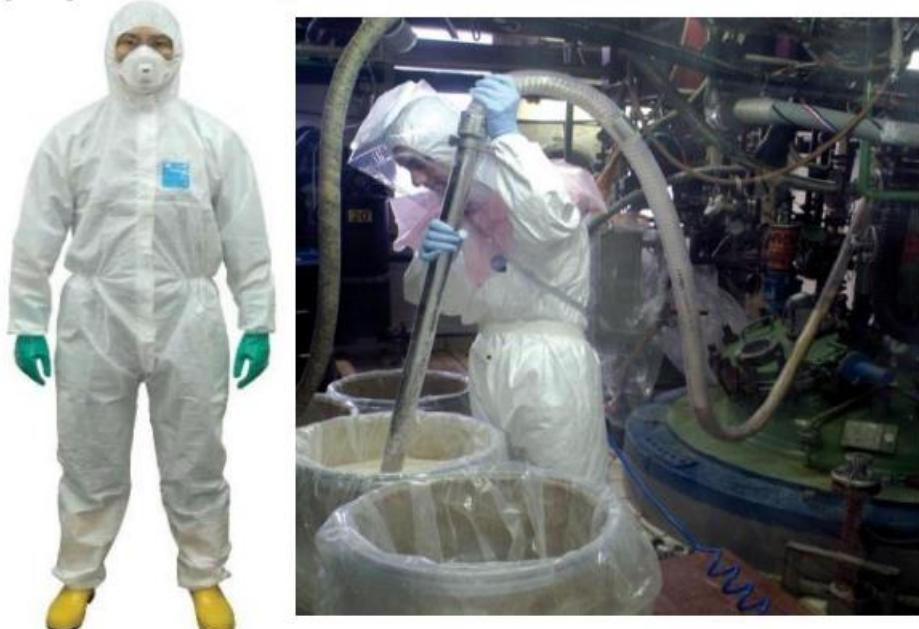
Slika 13 Odijelo za zaštitu od prskanja i aerosola [14]
