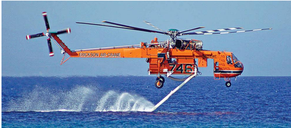
Slika 23. Punjenje preko hidrauličke cijevi u niskom letu [29]
