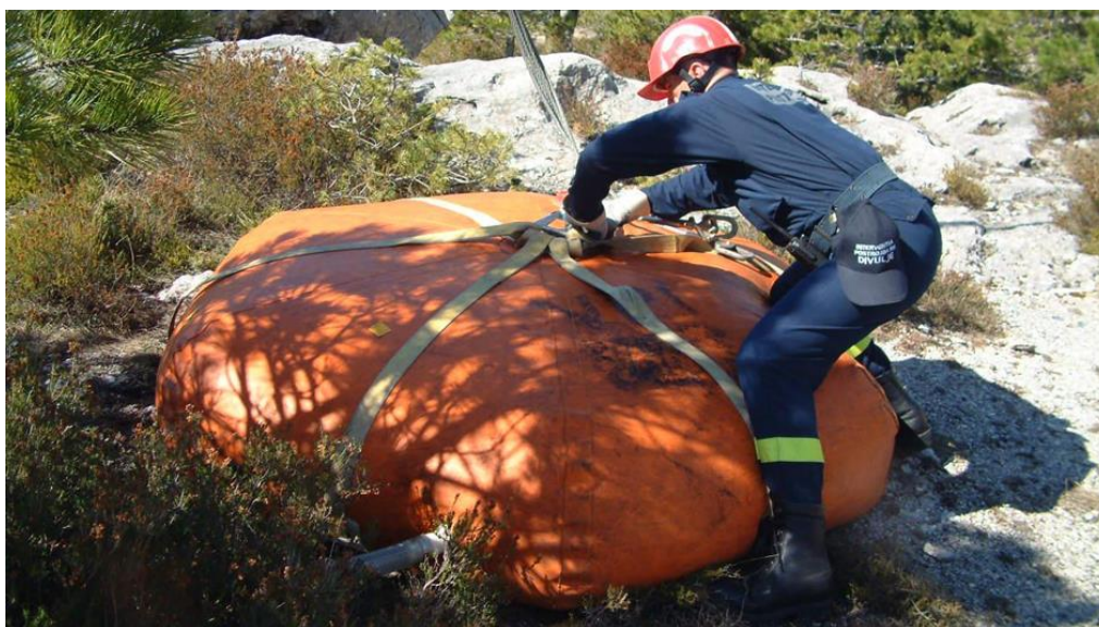
Slika 28. Gumeni spremnik Kruška [32]
