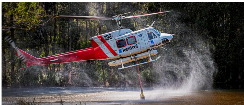
Slika 20. Podtrupni spremnik helikoptera [26]
