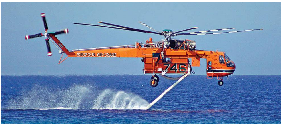
Slika 23. Punjenje preko hidrauličke cijevi u niskom letu [29]
