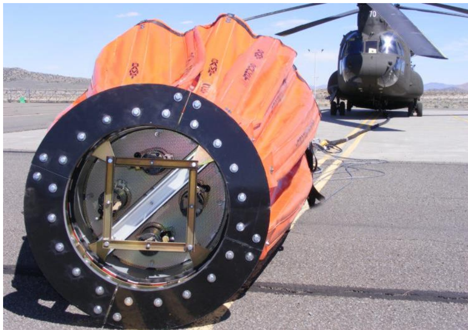
Slika 27. Zaimač Bambi Bucket sa Torrentula ventilom PowerFillom [33]
