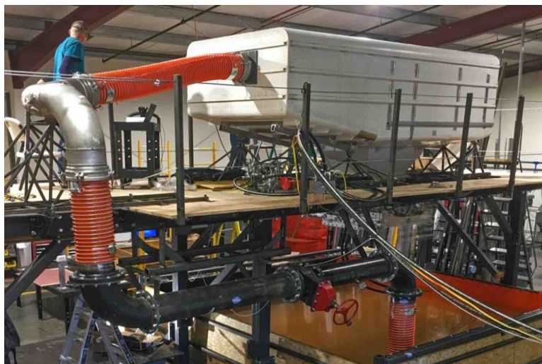
Slika 22. Ispitivanje spremnika helikoptera CH-47D Chinook [28]
