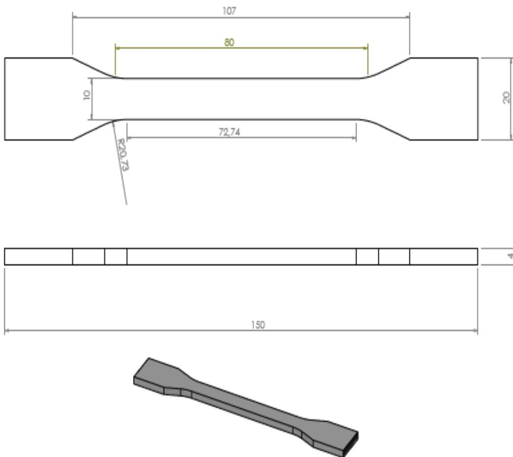
Slika 11. Prikaz ispitne epruvete
