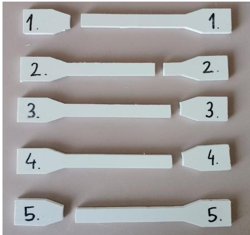
Slika 17. ABS poslije vlačnog ispitivanja
