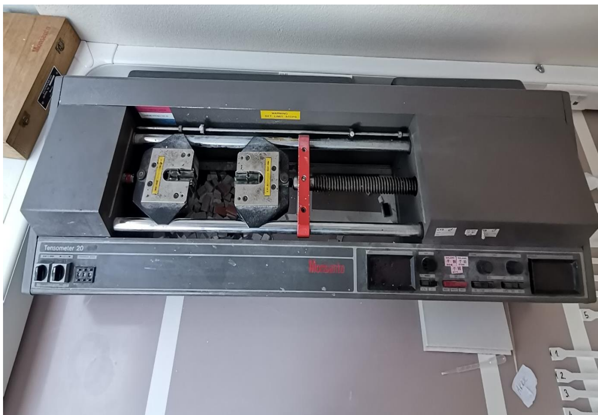
Slika 12. Kidalica Monsanto Tensometer 20
