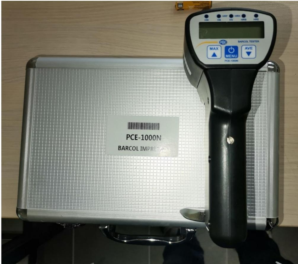
Slika 20. Barcol uređaj za ispitivanje tvrdoće
