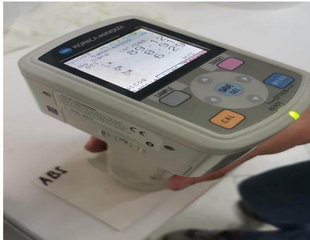
Slika 23. Mjerenje boje kolorimetrom, ABS
