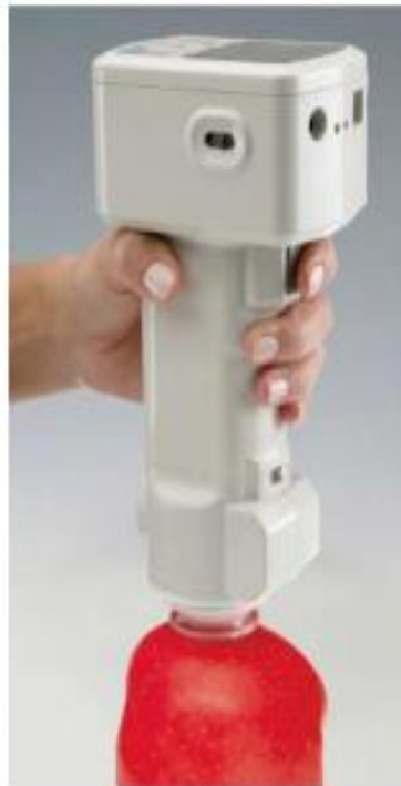
Slika 10. Kolorimetar i prikaz CIE prostora
