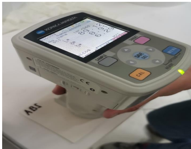
Slika 23. Mjerenje boje kolorimetrom, ABS
