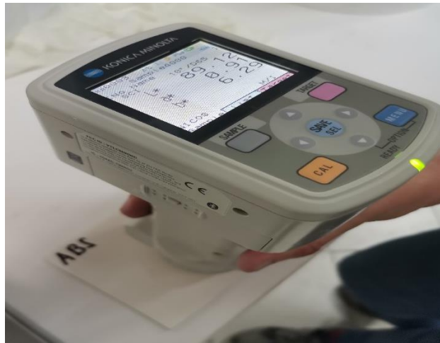
Slika 23. Mjerenje boje kolorimetrom, ABS
