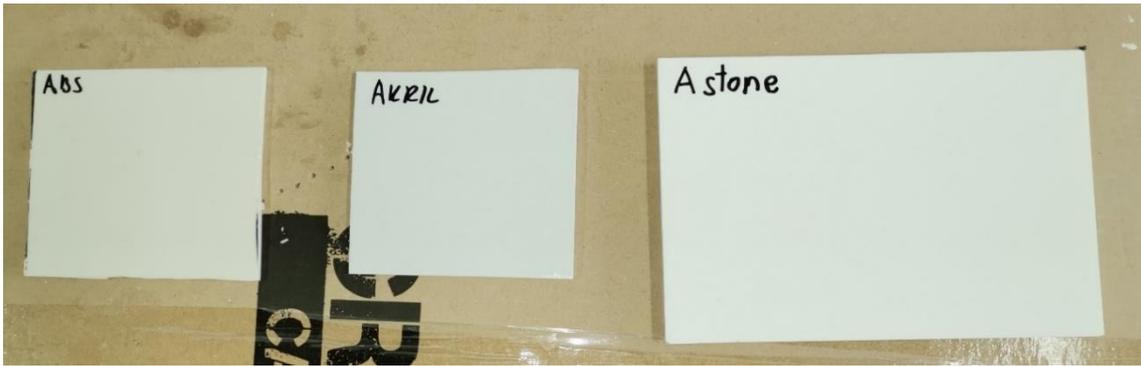
Slika 21. Prikaz ispitnih uzoraka za ispitivanje tvrdoće
