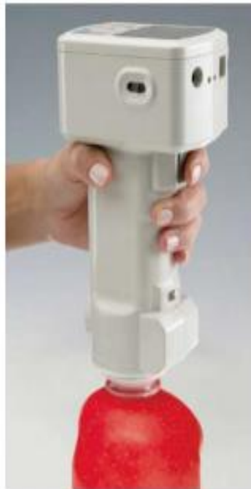
Slika 10. Kolorimetar i prikaz CIE prostora
