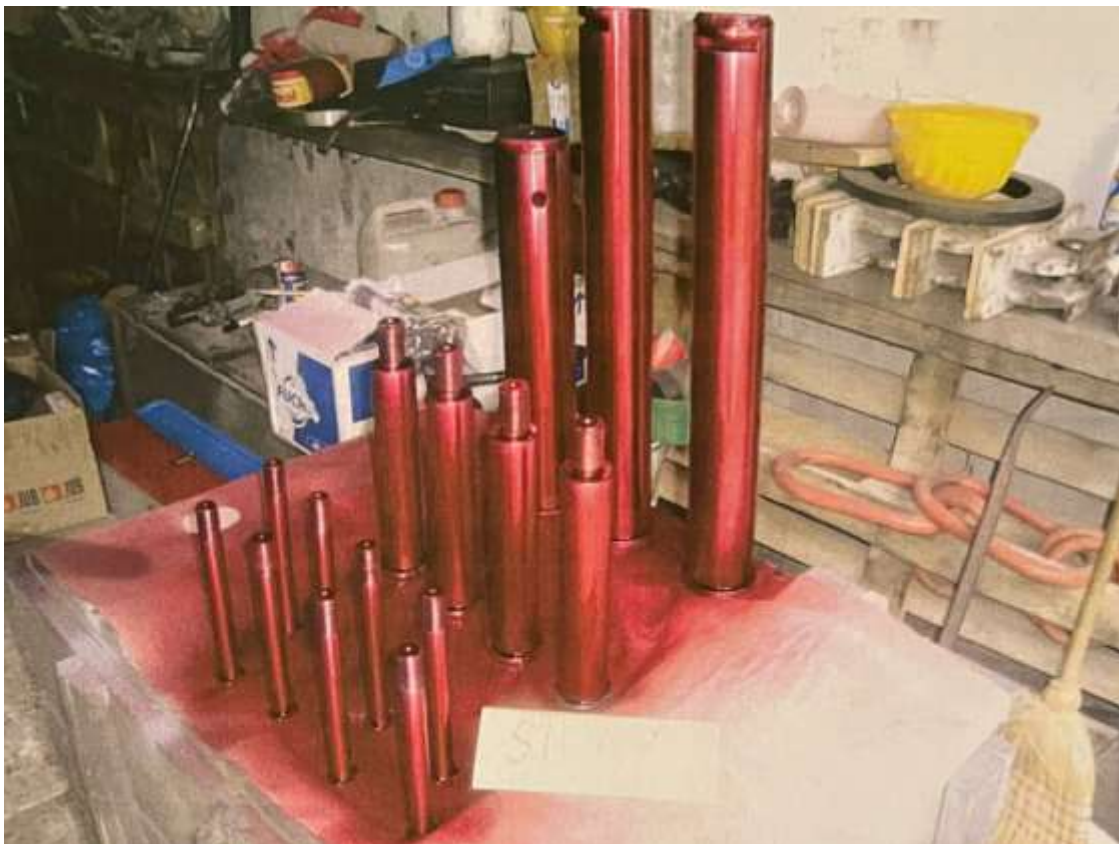
Slika 57 Penetrantsko ispitivanje svornjaka i osovina (1)
