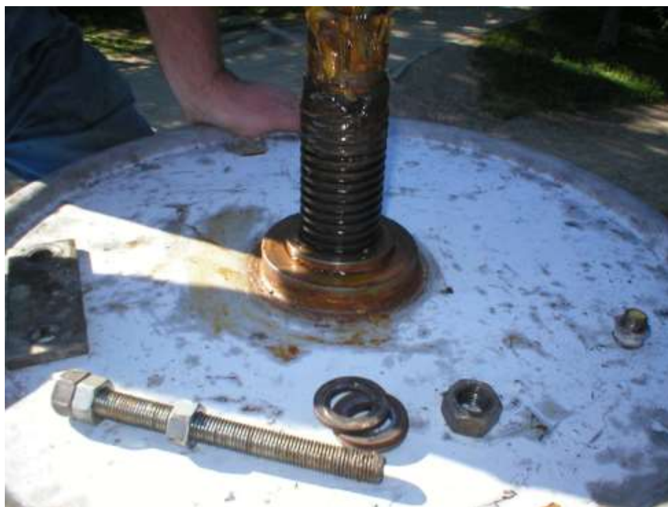
Slika 37 Podizanje dvodijelnog vratila (1)
