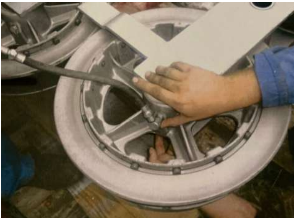
Slika 59 Podmazivanje ležajnih sklopova nakon zamjene ležaja, bojanja i zamjene mazalica
