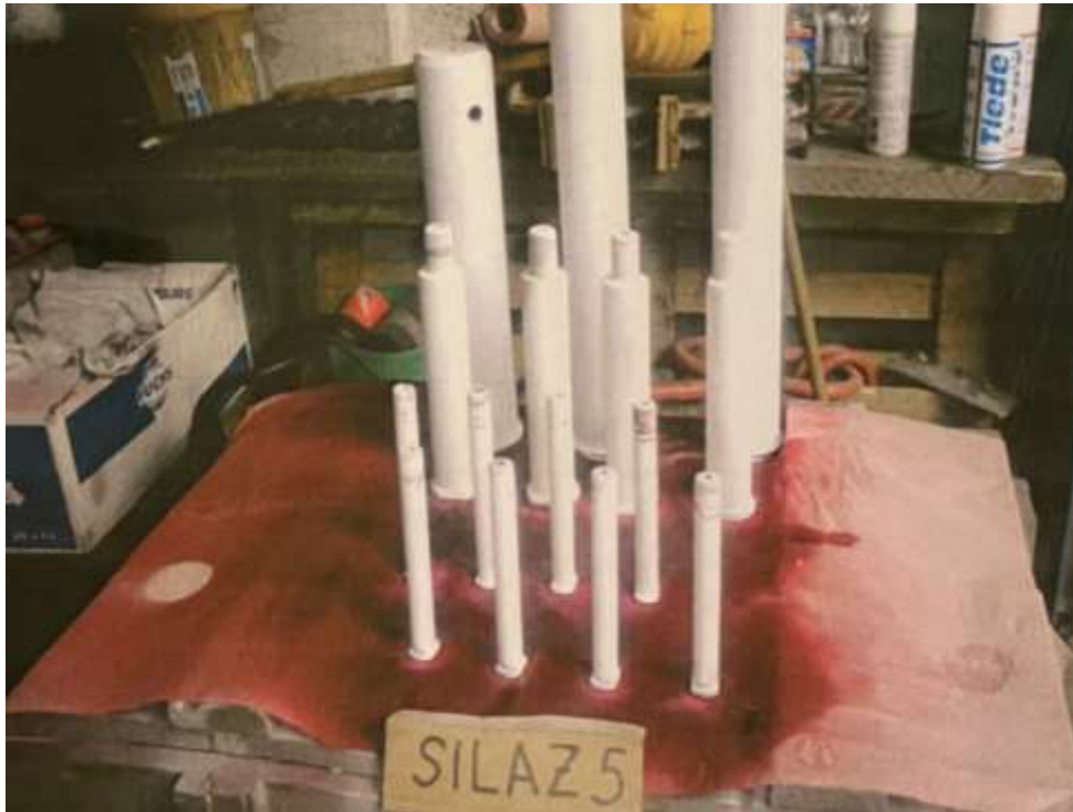
Slika 58 Penetrantsko ispitivanje svornjaka i osovina (2)
