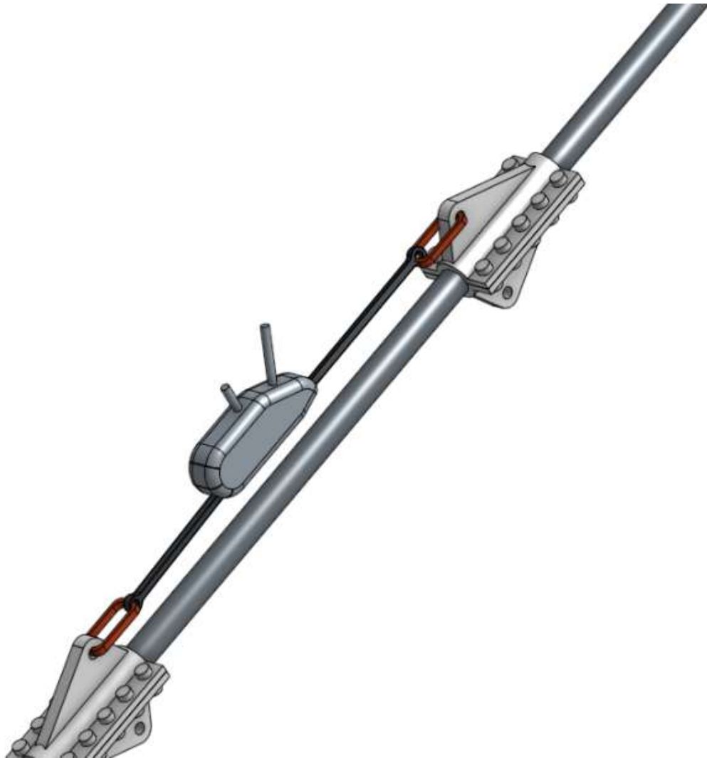
Slika 29 Natezanje užeta pomoću tirfora i klema
