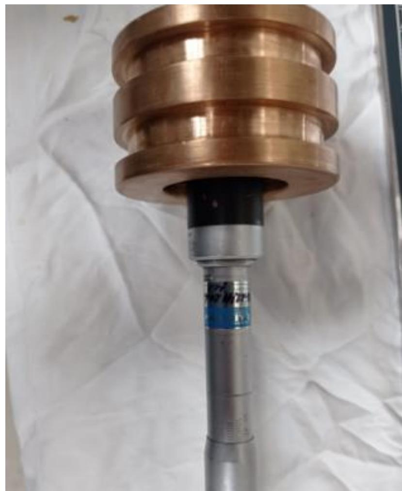
Slika 27. Nosač brtvila,  $\phi$  unutrašnji
