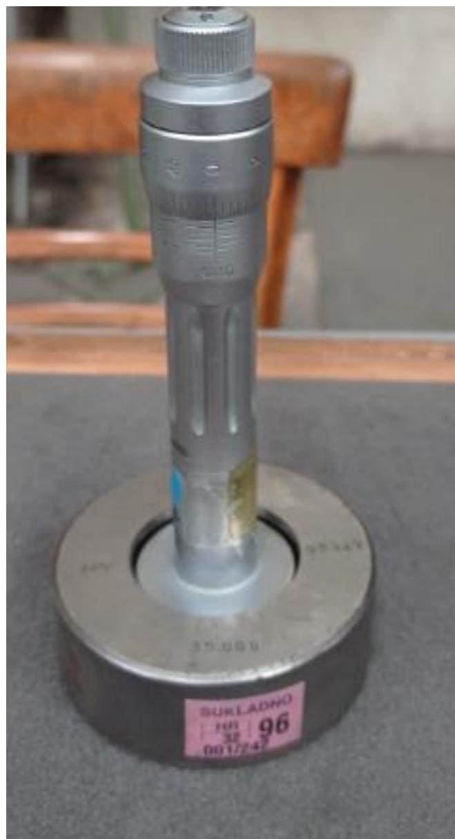
Slika 10. Umjeravanje mikrometra za unutrašnje mjerjenje
