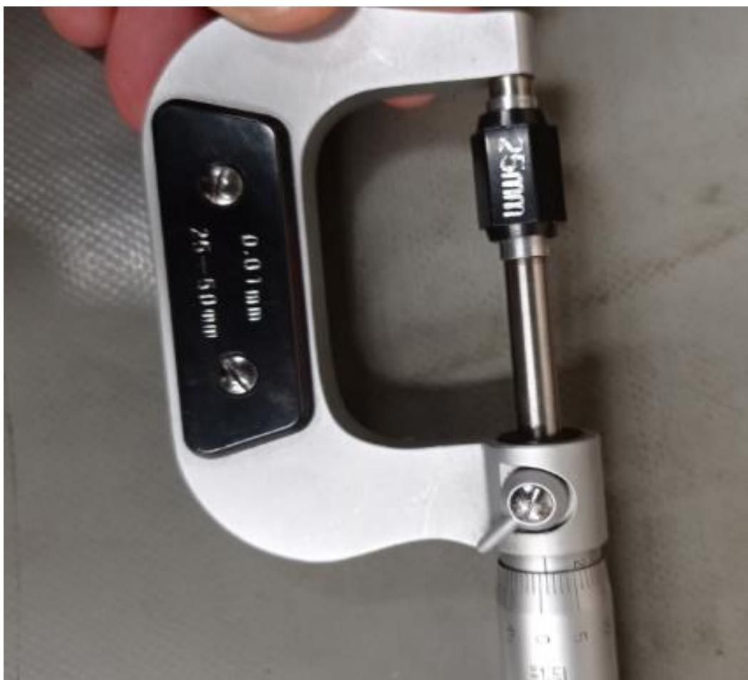
Slika 9. Umjeravanje mikrometra
