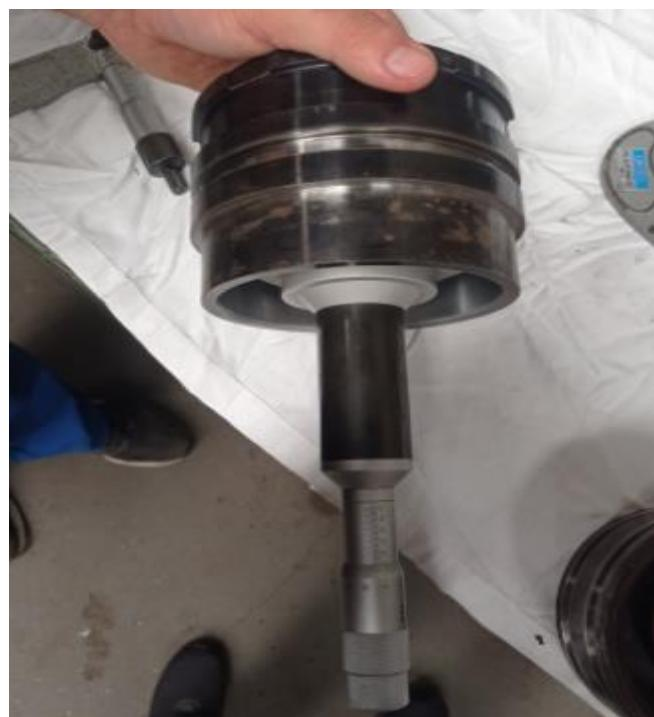
Slika 20. Tijelo kompenzatora,  $\phi$  unutrašnji
