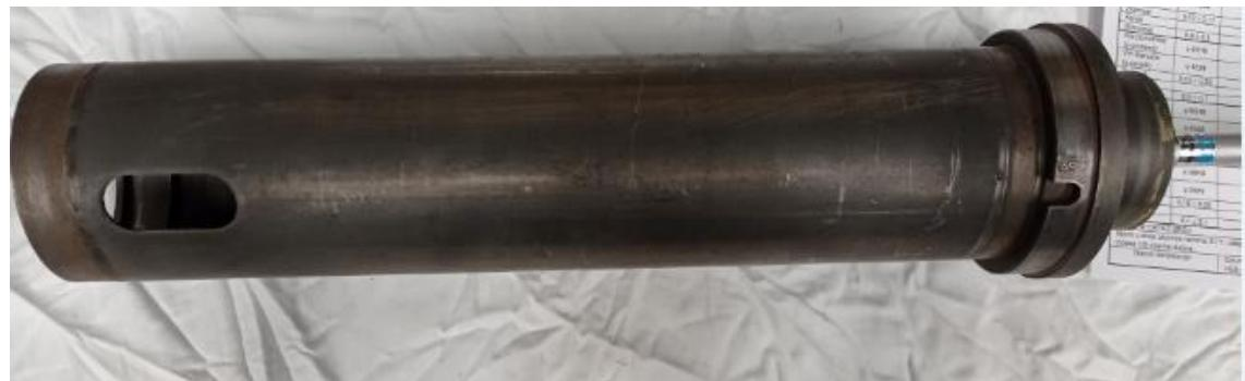
Slika 29. Cilindar srednji,kutija brtvljenja,  $\phi$  unutrašnji
