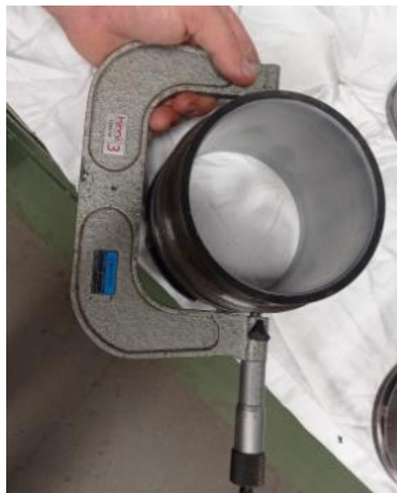
Slika 23. Tijelo kompenzatora ,  $\phi$  vanjski
