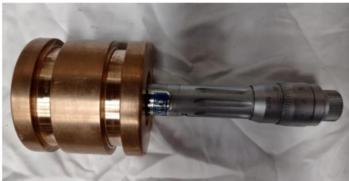
*Slika 31. Nosač brtvila,  $\phi$  unutrašnji*
