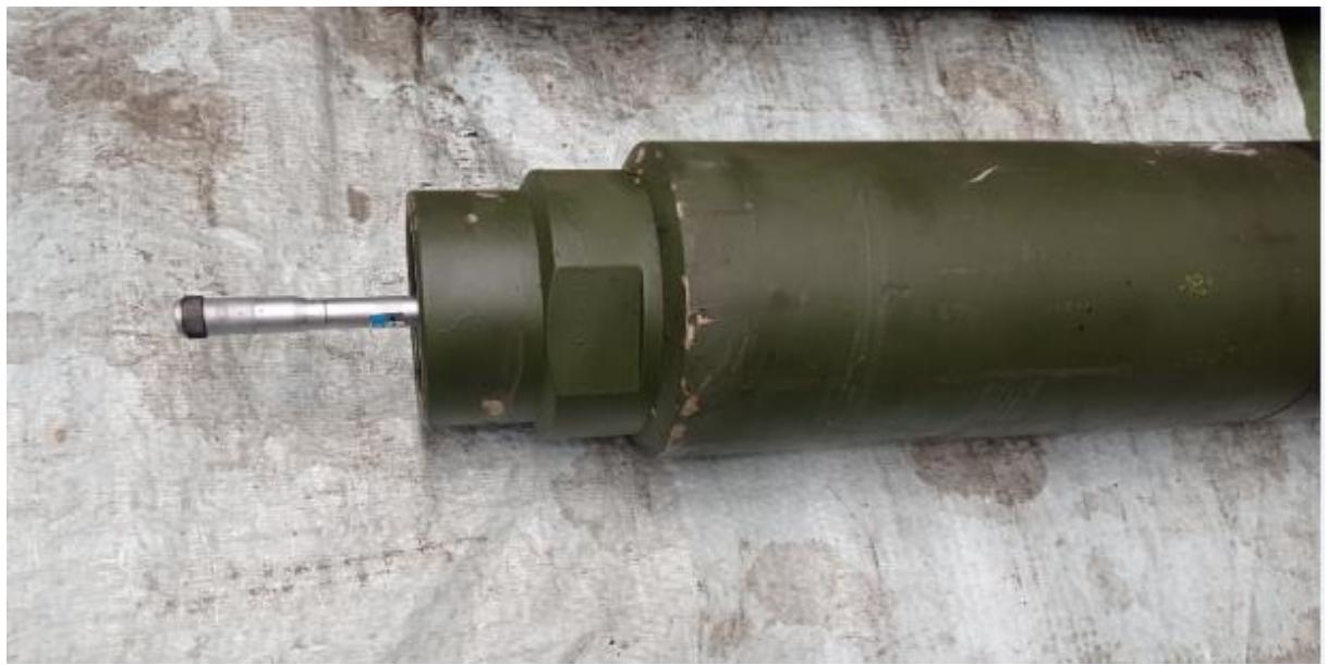
Slika 14. Cilindar hidraulične kočnice,  $\phi$  unutrašnji
