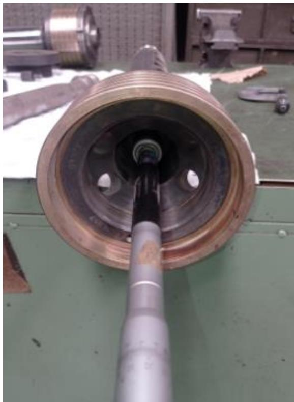
Slika 18. Klipnjača,  $\phi$  unutrašnji
