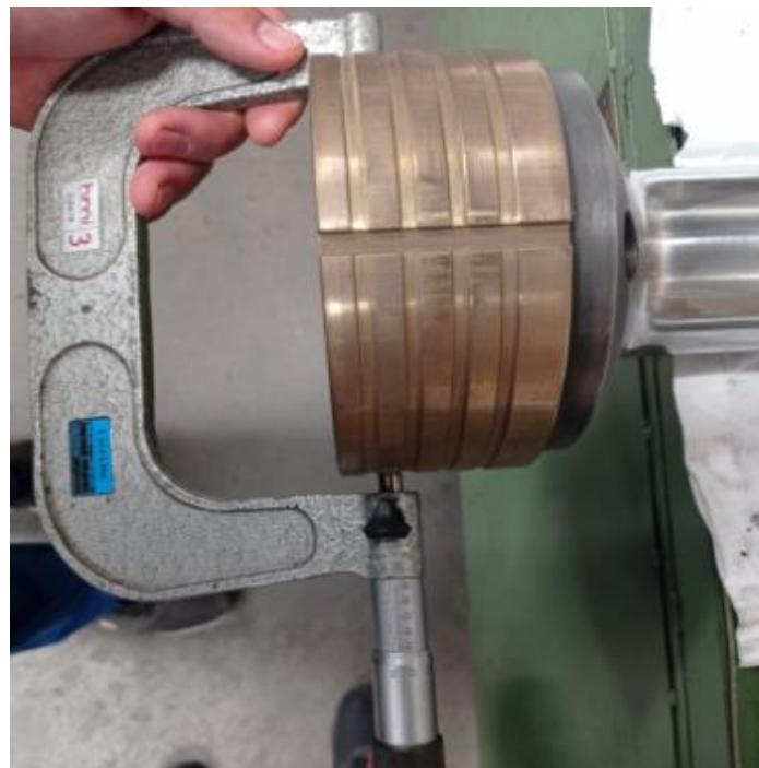
Slika 13. Košuljica klipnjače  $\phi$  vanjski
