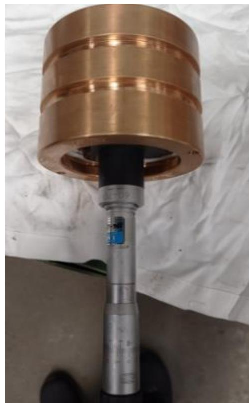
Slika 16. Nosač brtvila,  $\phi$  unutrašnji
