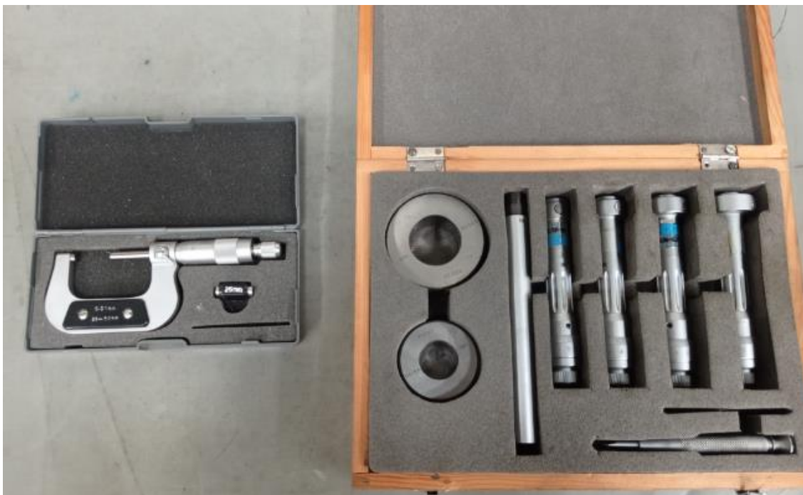
Slika 7. Mjerni uređaji sa etalonima za kontrolu
