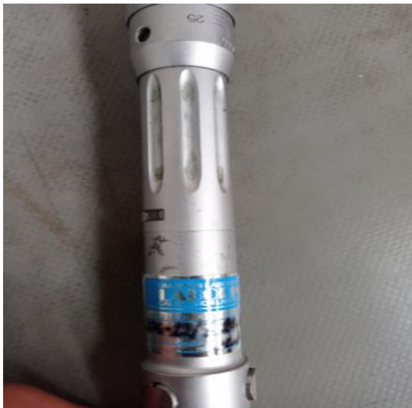
Slika 8. Naljepnica umjerenog uređaja ovlaštenog mjeriteljskog laboratorija
