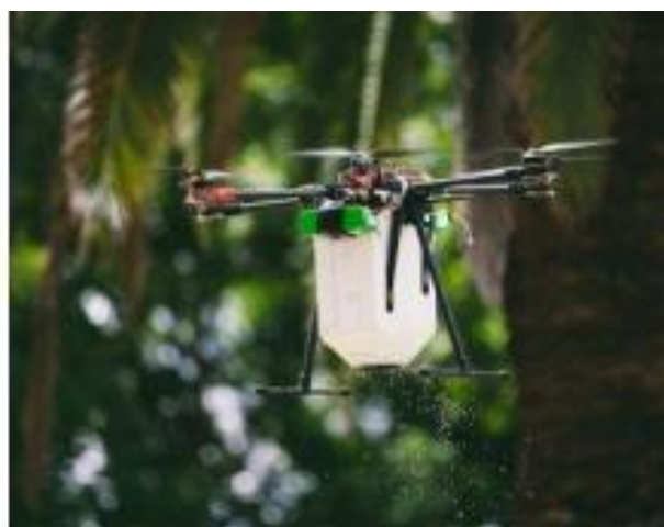
Slika 8: „Bug drone“ tijekom raspršivanja prirodnih neprijatelja štetnika
