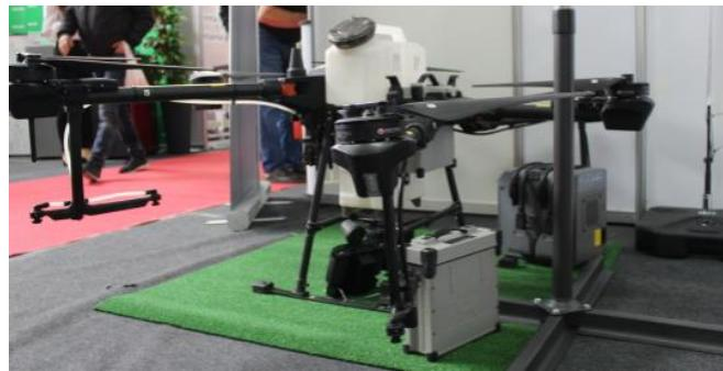
Slika 2: Teretni dron za raspršivanje pesticida
