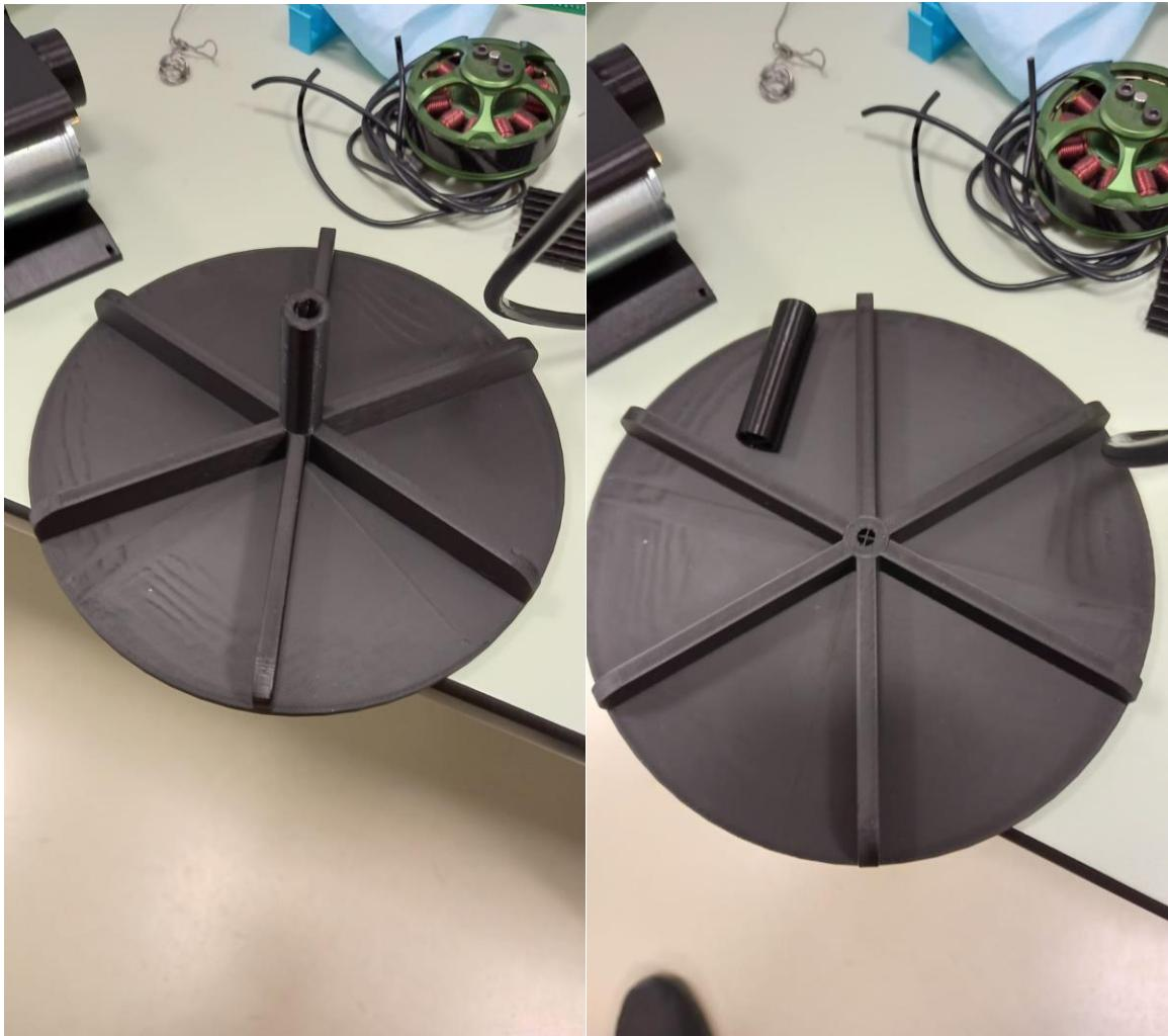
Slika 24: Rotor (lijevo) i greška na rotoru (desno)
