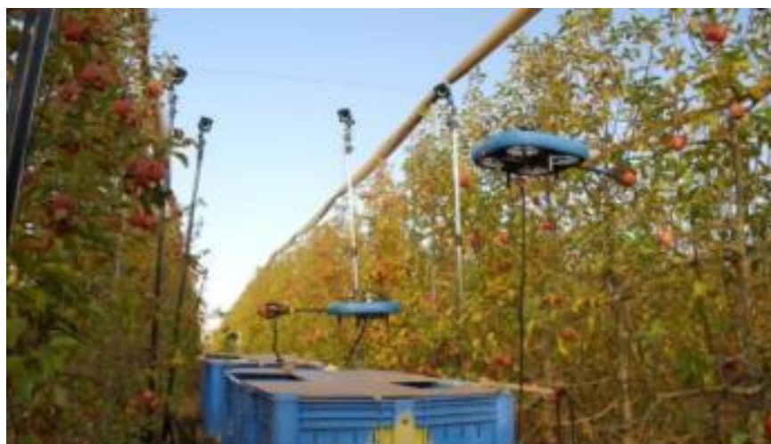
Slika 10: Autonomna platforma za branje jabuka
