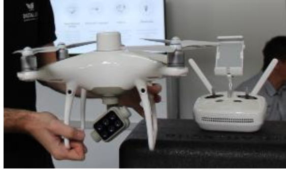
Slika 1: Dron sa multispektralnom kamerom
