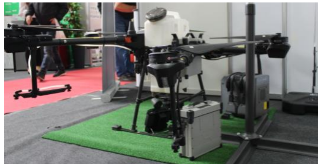
Slika 2: Teretni dron za raspršivanje pesticida
