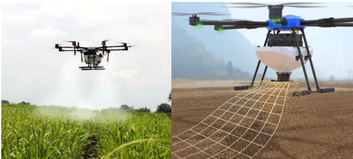
Slika 4: Teretni dronovi za raspršivanje pesticida i sjemenki
