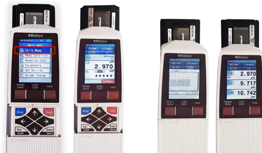
Slika 62. Postupak umjeravanja mjernog uređaja
