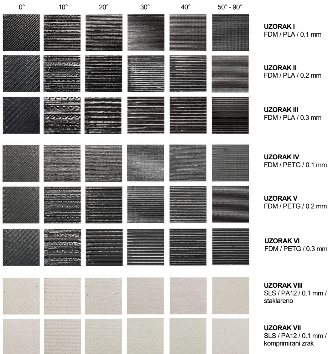
Slika 74. Prikaz površine probnih uzoraka pri vizualnoj kontroli
