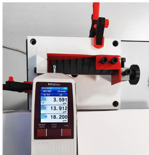
Slika 67. Postupak mjerenja hrapavosti za jednu površinu
