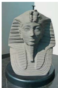
Slika 9. Princip aditivnih postupaka proizvodnje prototipova [4]
