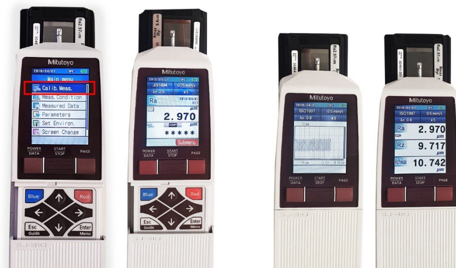
Slika 62. Postupak umjeravanja mjernog uređaja
