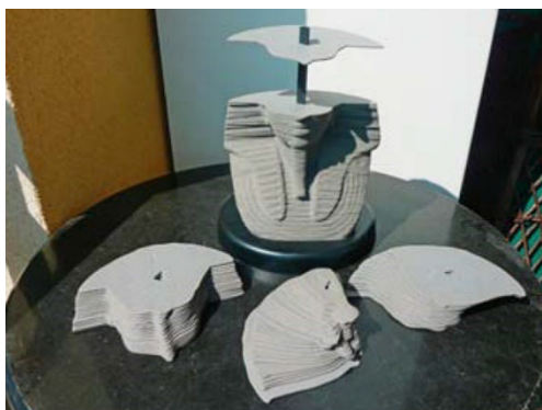
Slika 9. Princip aditivnih postupaka proizvodnje prototipova [4]
