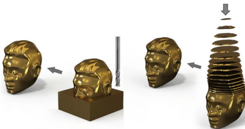
Slika 7. Usporedba subtraktivne i aditivne proizvodnje [8]
