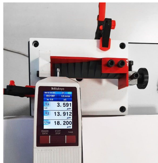
Slika 67. Postupak mjerenja hrapavosti za jednu površinu
