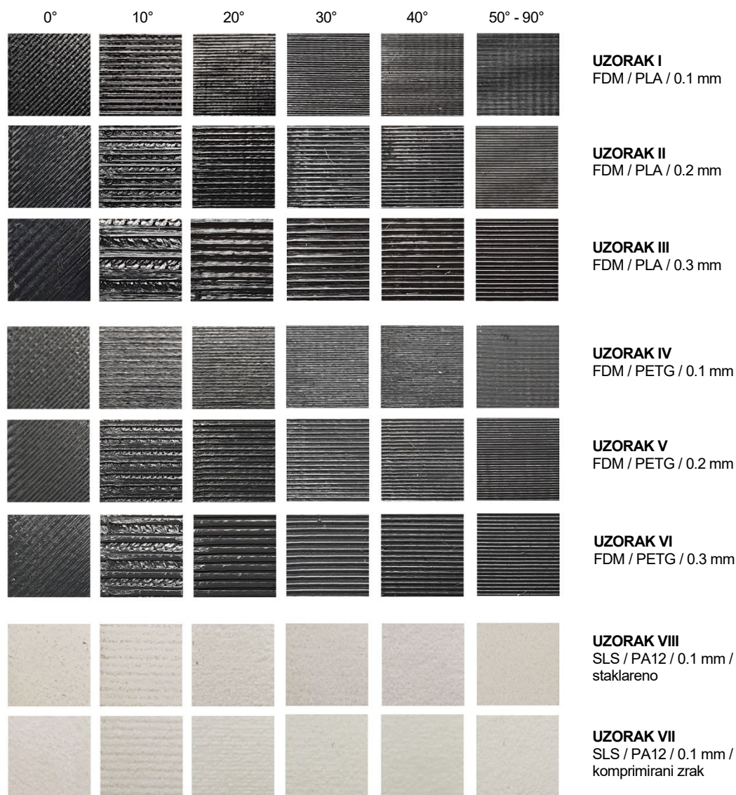
Slika 74. Prikaz površine probnih uzoraka pri vizualnoj kontroli
