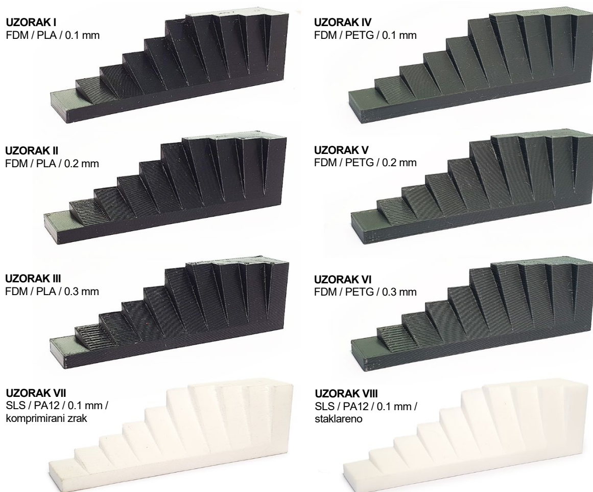
Slika 66. Izrađeni probni uzorci s karakteristika za provedbu mjerenja
