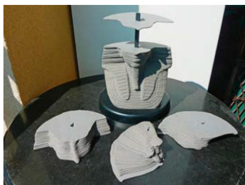
Slika 9. Princip aditivnih postupaka proizvodnje prototipova [4]
