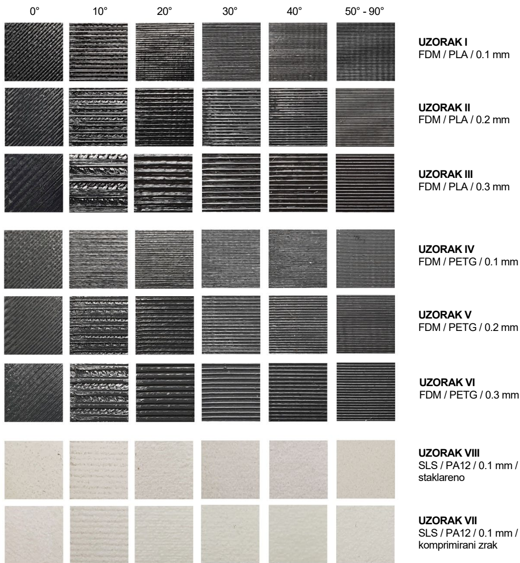
Slika 74. Prikaz površine probnih uzoraka pri vizualnoj kontroli
