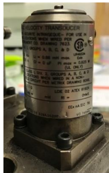
Slika 27. Pretvarač brzine ; Izvorno autor
