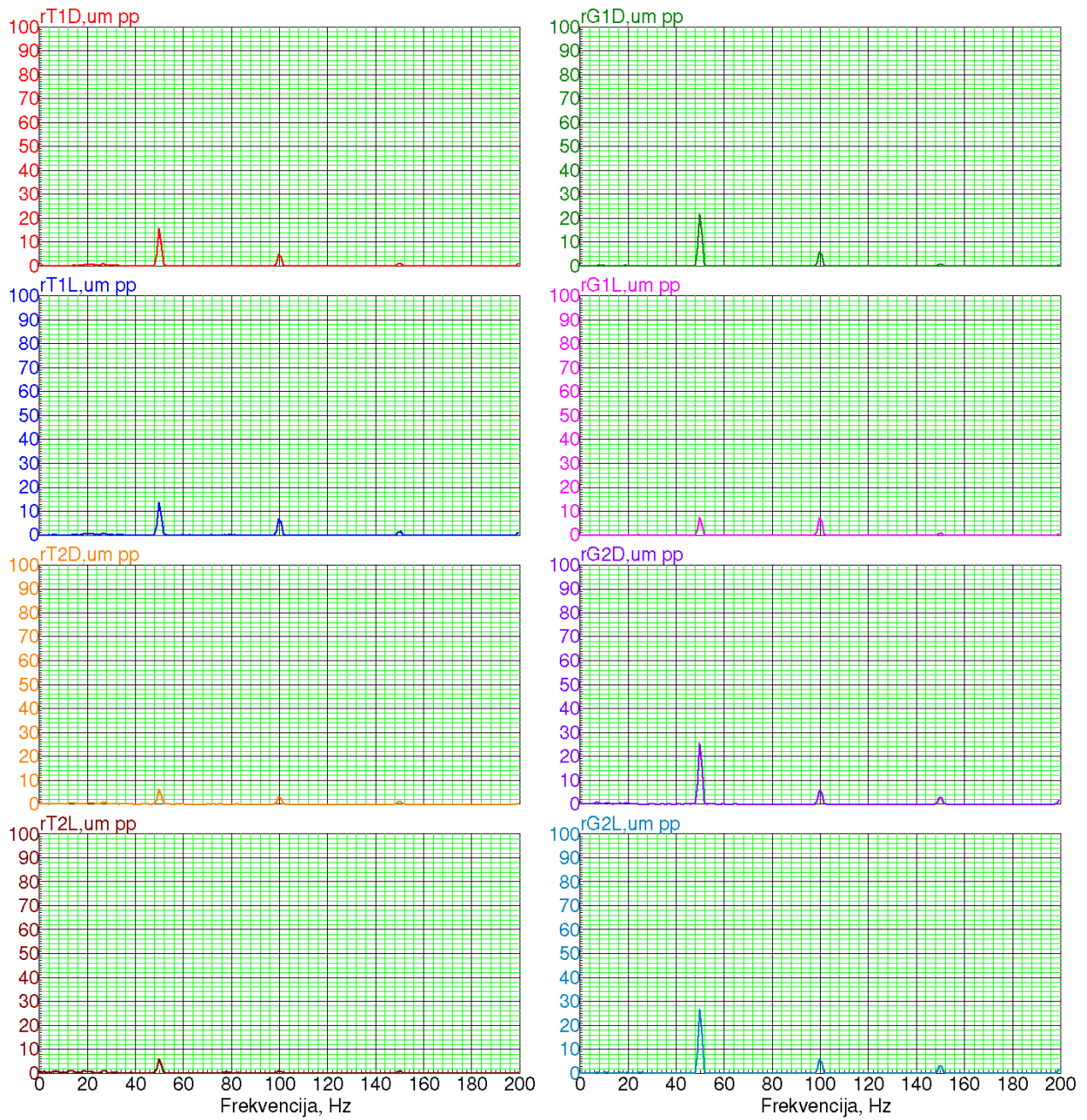
Dijagram 15. Frekvencijski spektar kod punog opterećenja i uključenih oduzimanja ; Izvorno autor
