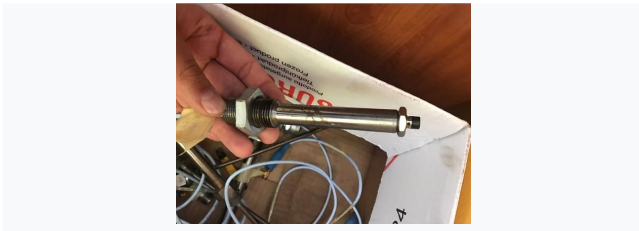
Slika 26. Pretvarač pomaka ; Izvorno autor
