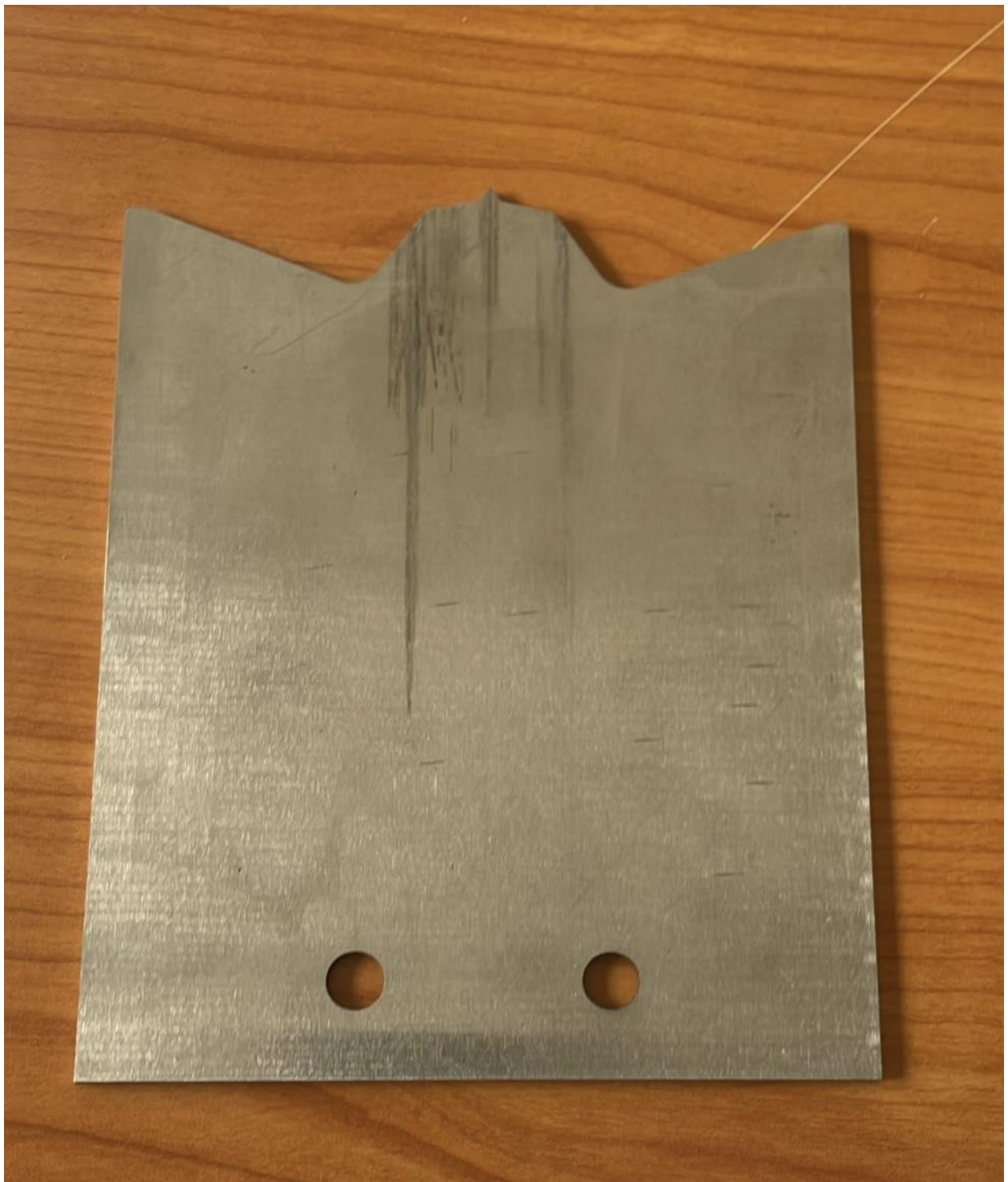
Slika 19 Slika noža prije nanošenja PVD prevlake TiN (vlastiti izvor)
