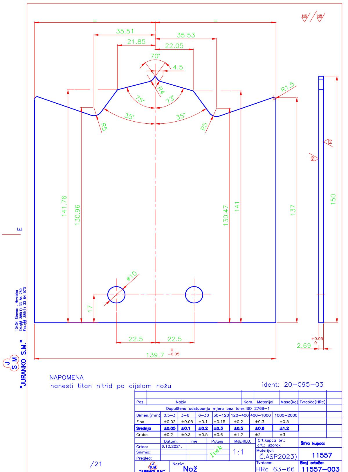
Slika 20 Tehnički nacrt slike noža (vlastiti izvor)
