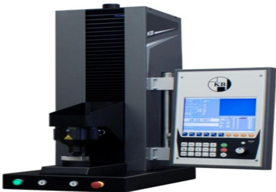
Slika 27 Digitalni tvrdomjer KBE 150 R [9]
