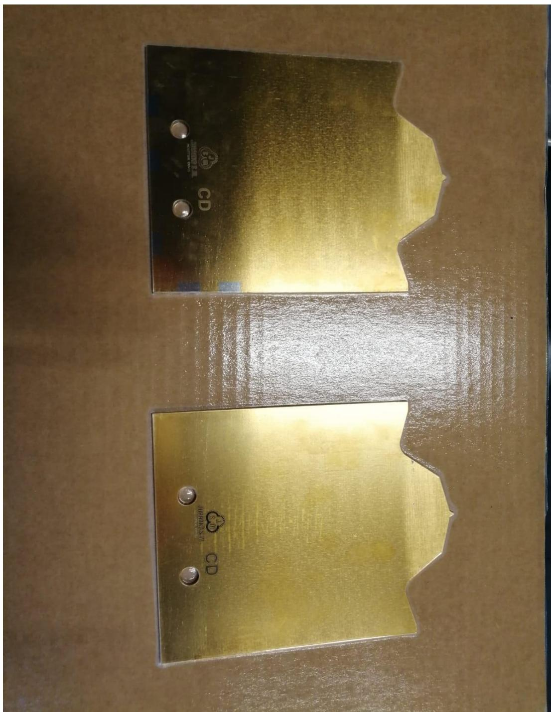
Slika 24 Noževi nakon PVD obrade (vlastiti izvor)
