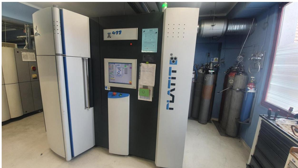
Slika 22 Stroj za elektrolučno nanošenje PVD prevlake PLATIT π411 (vlastiti izvor)
