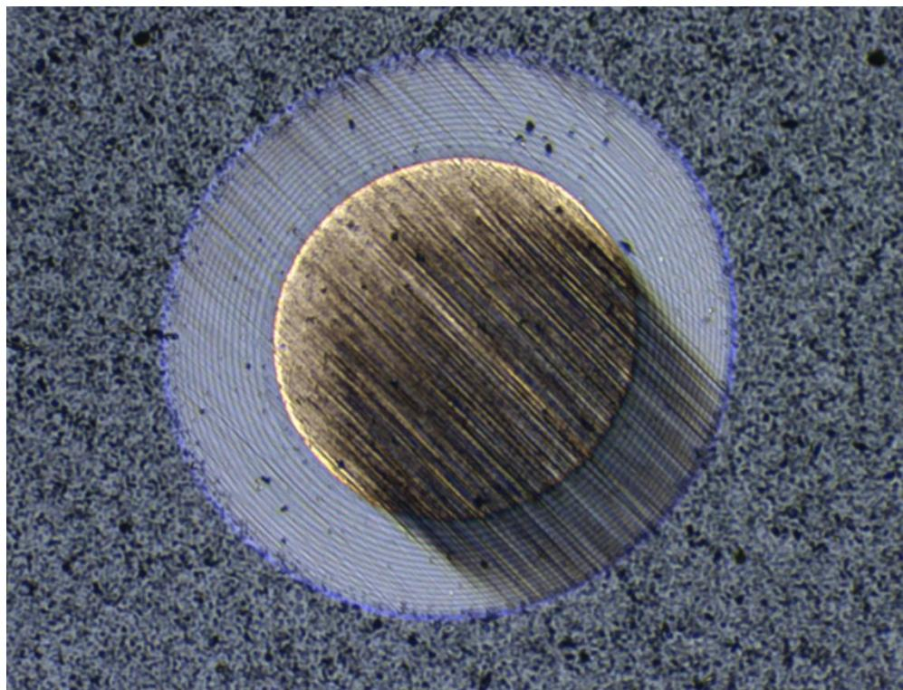
Slika 26 Multislojna TiN prevlaka (vlastiti izvor)
