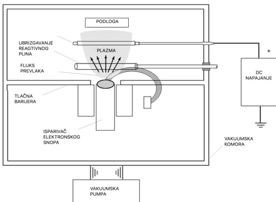
*Slika 10 Proces isparivanja visokoreaktivnog plina koristeći pištolj za isparivanje snopom elektrona [5]*
