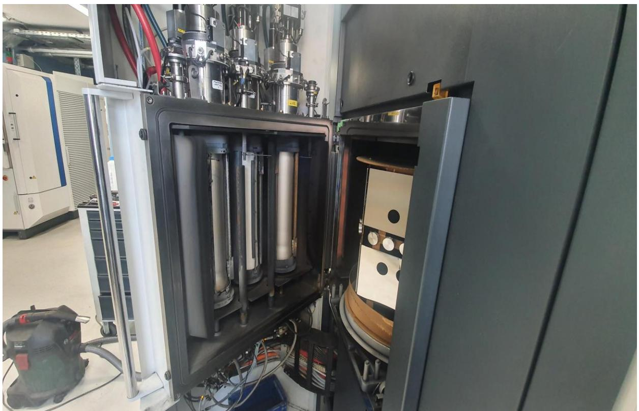
Slika 23 Slika unutarnje komore PLATIT  $\pi$ 411 (vlastiti izvor)
