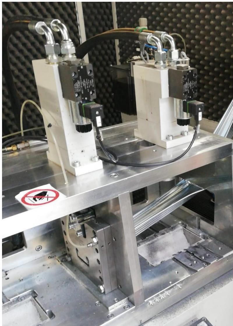
*Slika 21 Slika prevelikog zagrijavanja te zapinjanja noža u vodilici u trenutku rezanja
