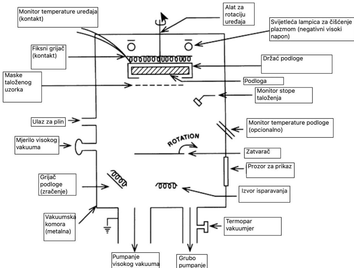
Slika 8 Tipična vakuumska komora za taloženje [7]
