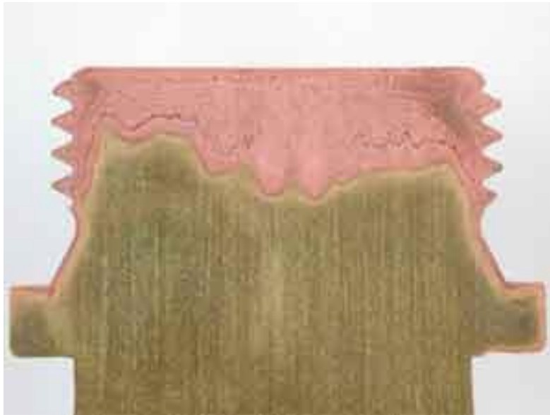
Slika 10. Selektivna korozija – decinkacija [21]
