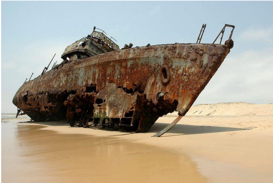
Slika 2. Koroziija trupa broda [6]
