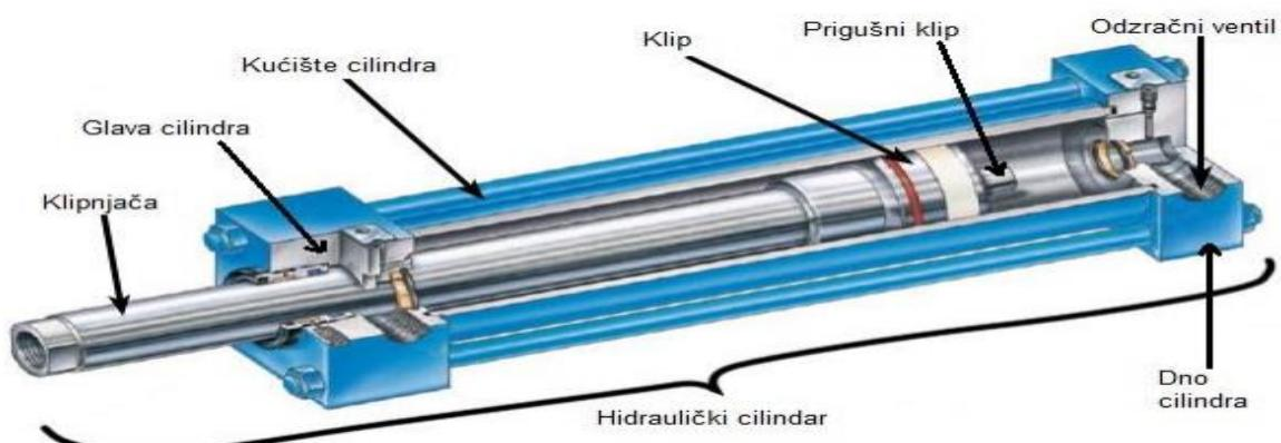
Slika 25. Hidraulički cilindar [21]
