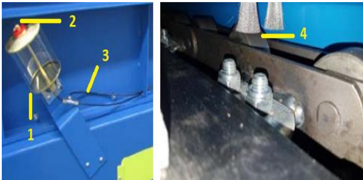
Slika 32. Sklop za podmazivanje lanca [13]
