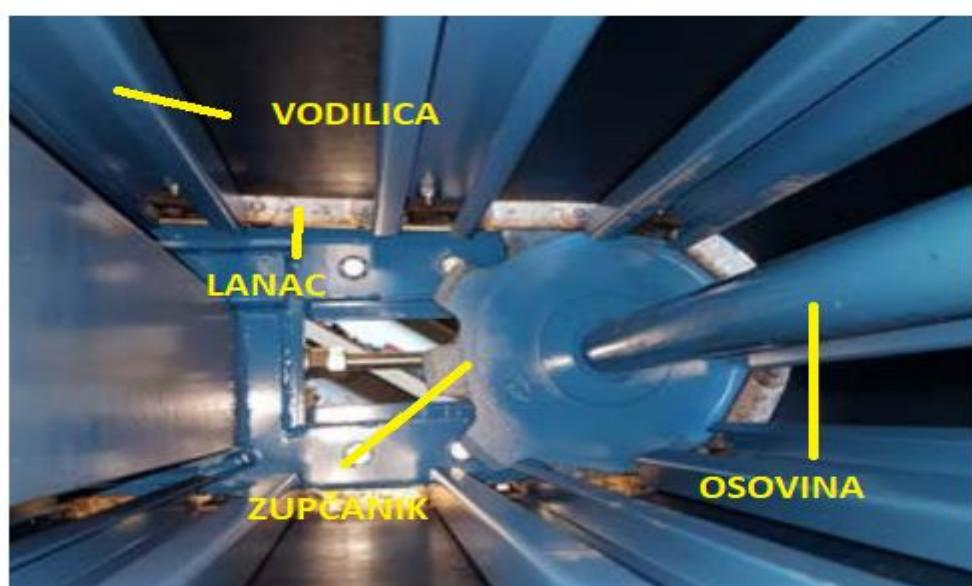
Slika 30. Sklop za pokretanje transportne trake [13]
