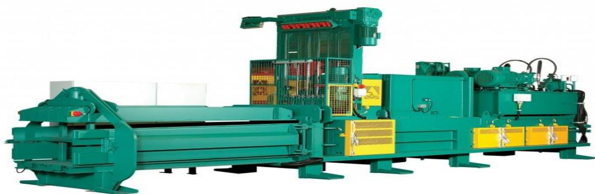
Slika 6. Horizontalna hidraulička preša AVOS -1810 [7]
