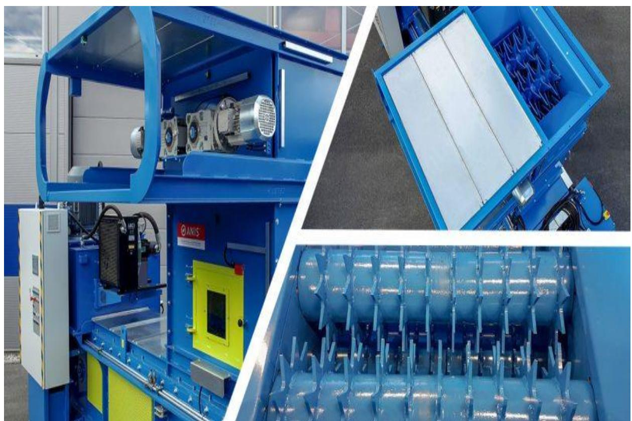
Slika 7. Perforator na hidrauličkoj preši [8]
