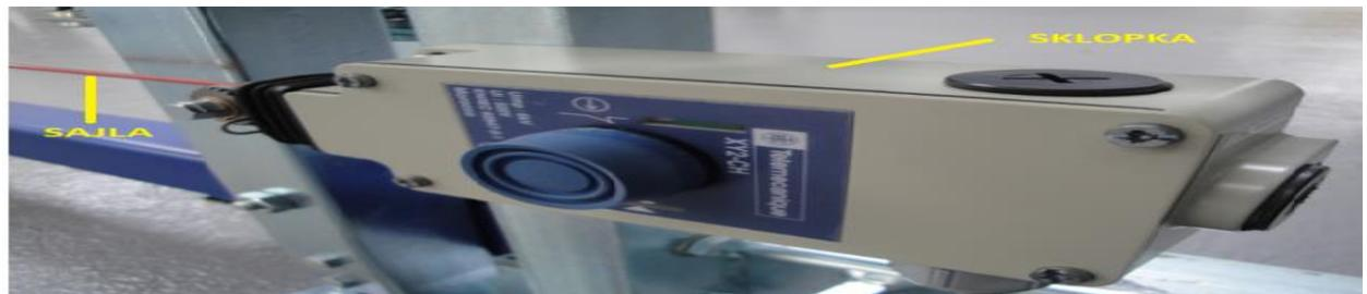
Slika 34. Elektro - mehanička sklopka [29]
