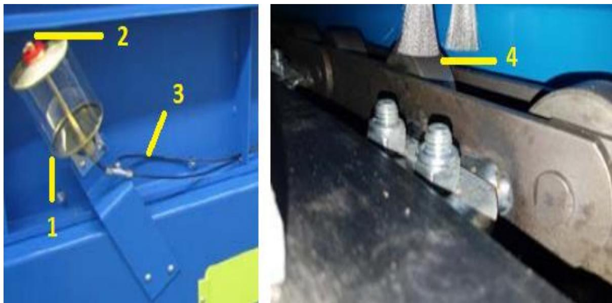
Slika 32. Sklop za podmazivanje lana [13]
