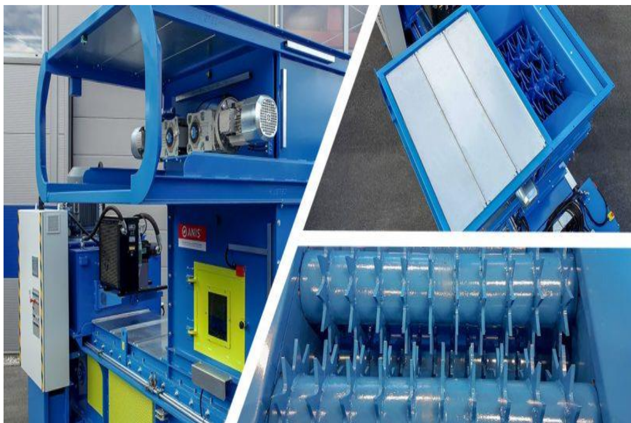
Slika 7. Perforator na hidrauličkoj preši [8]
