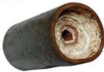
Slika 18. Prikaz cijevi s nakupinama kamenca
