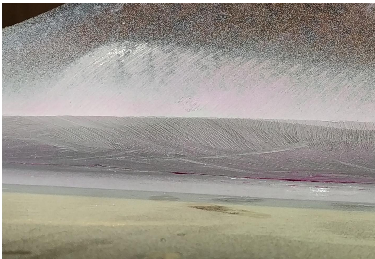
Slika 45. Indikacija prilikom ispitivanja penetrantskom kontrolom
