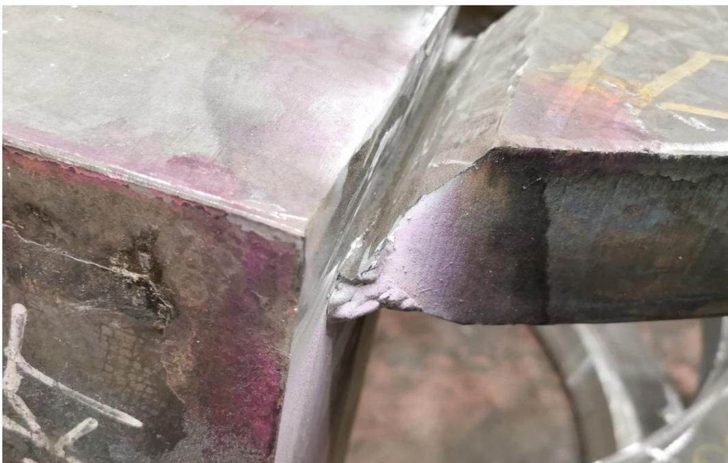
Slika 46. Izgled spoja nakon penetrantskog ispitivanja i brušenja
