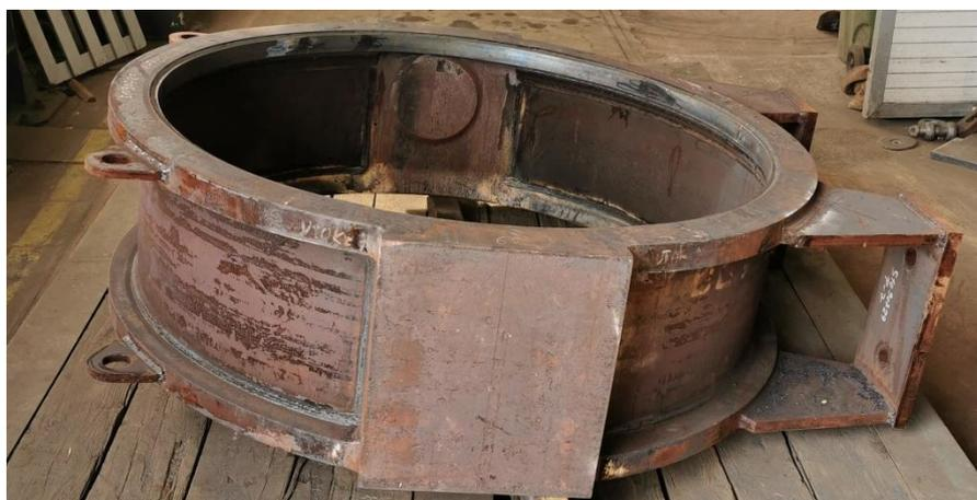
Slika 68. Izgled kućišta nakon toplinske obrade
