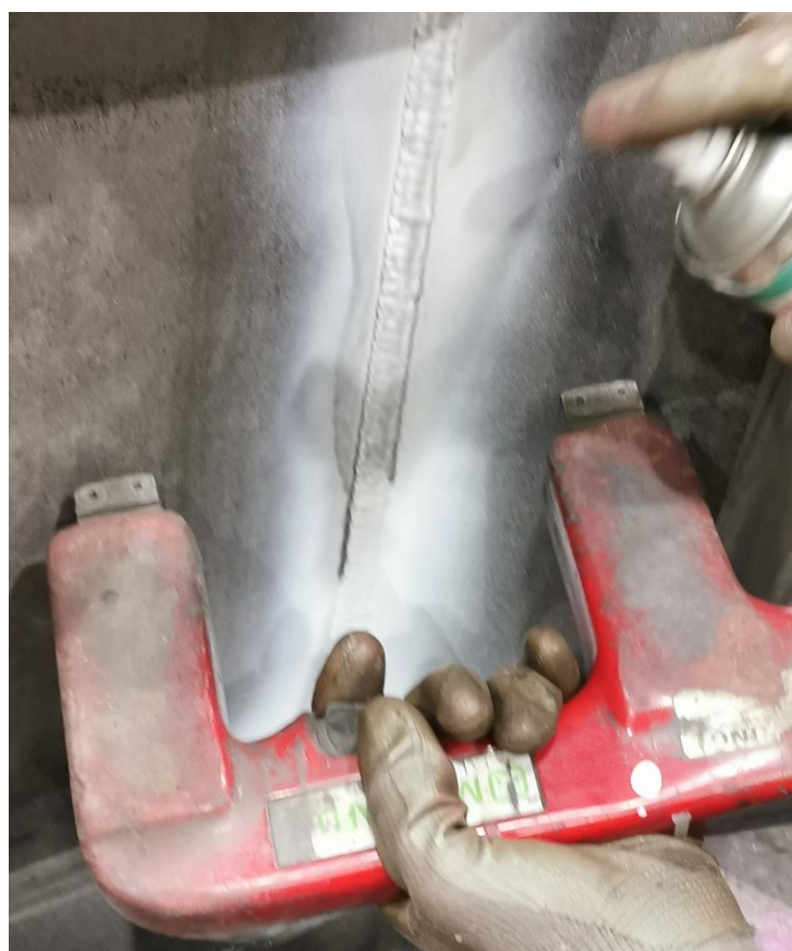
Slika 54. Prikaz rada magnetskom kontrolom obojanim česticama
