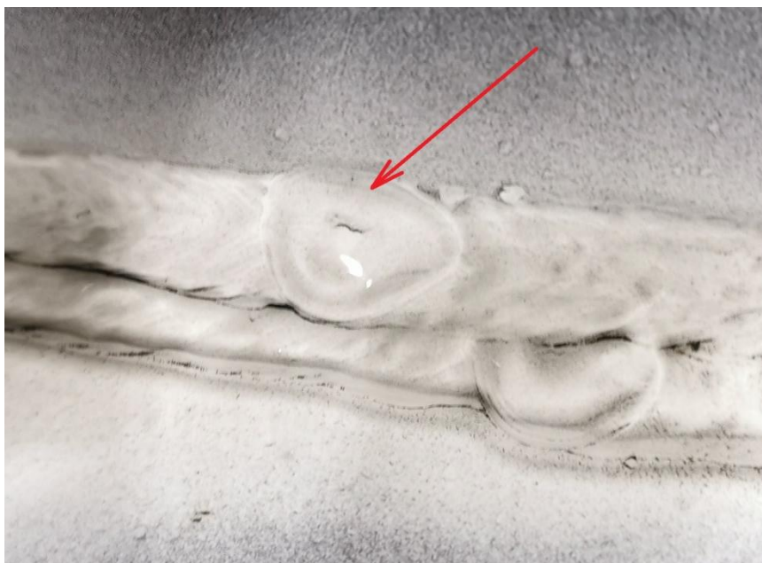
Slika 53. Pukotina u završnom krateru
