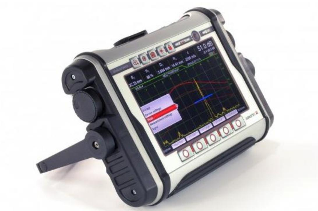
Slika 30. Digitalni ultrazvučni uređaj [43]
