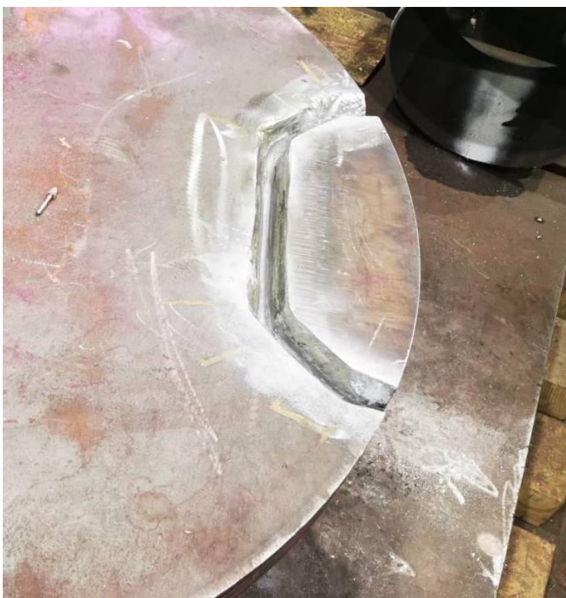
Slika 60. Penetrantska kontrola nakon brušenja korijena zavarenog spoja „diska“ i „kocke“
