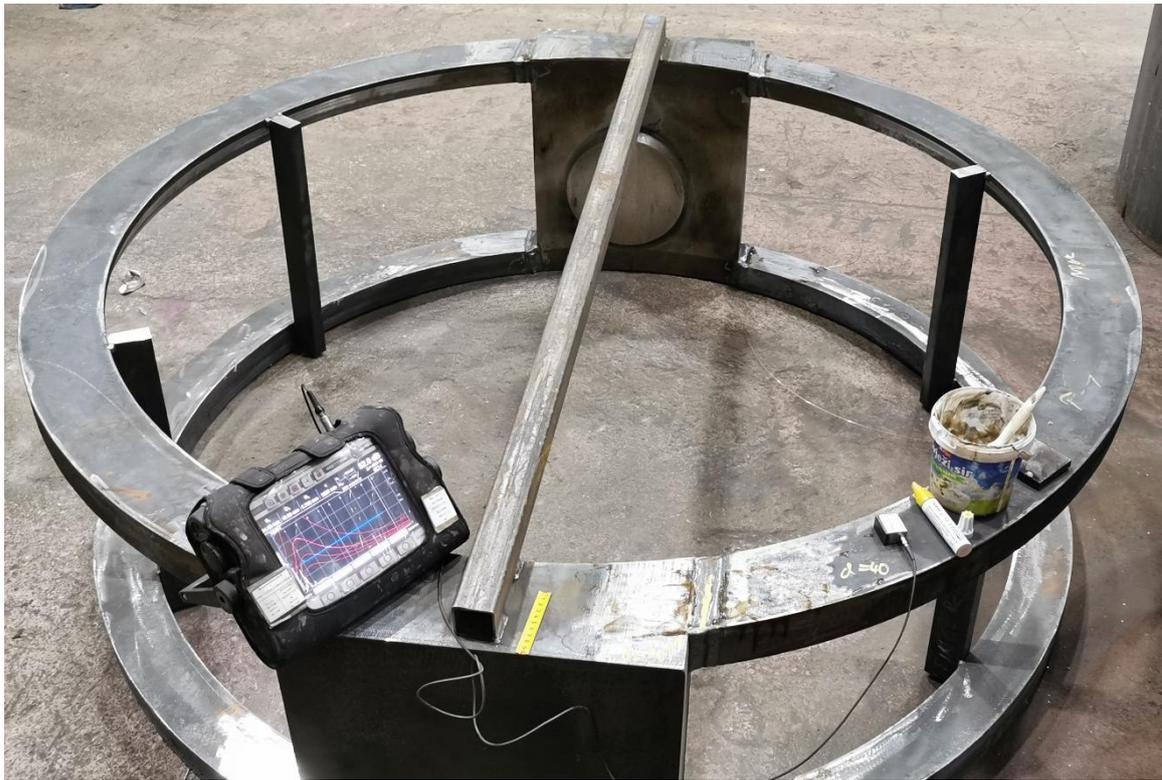
Slika 49. Ultrazvučna kontrola jednog od osam spojeva
