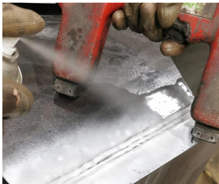
Slika 57. Magnetska kontrola zavarenog spoja „stope“
