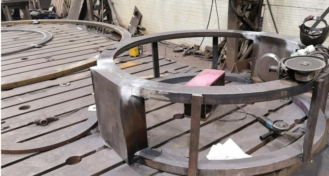
Slika 48. Ispitivanje magnetskom kontrolom četiri od osam spojeva
