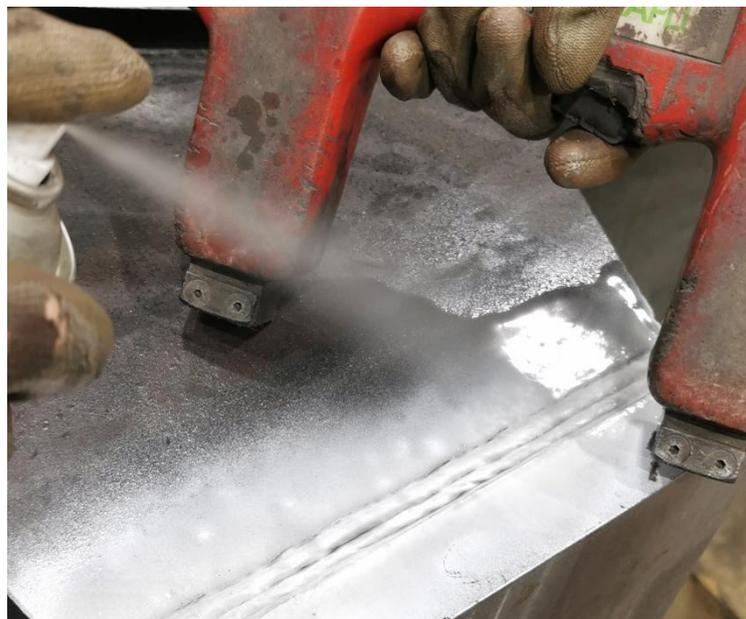
Slika 57. Magnetska kontrola zavarenog spoja „stope“
