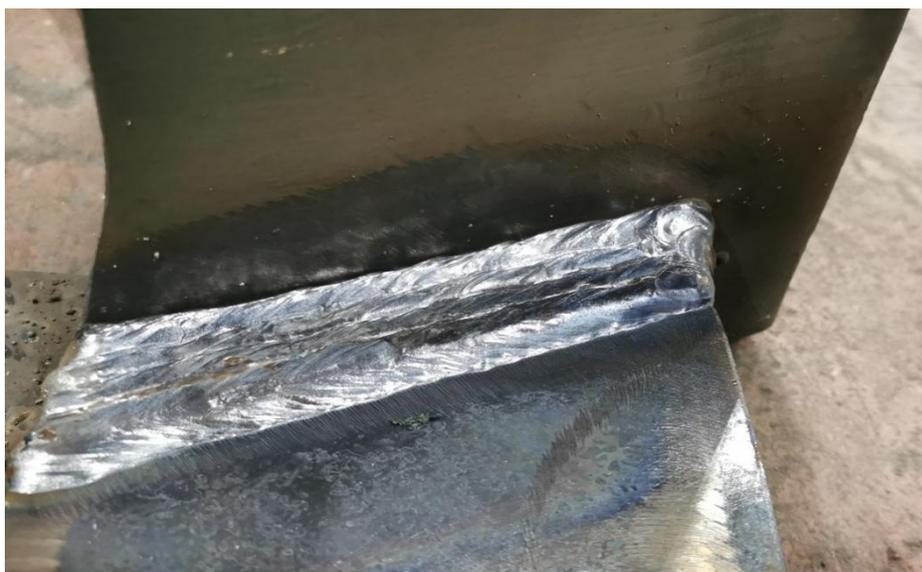
Slika 47. Vizualna kontrola lica zavara jednog od osam spojeva
