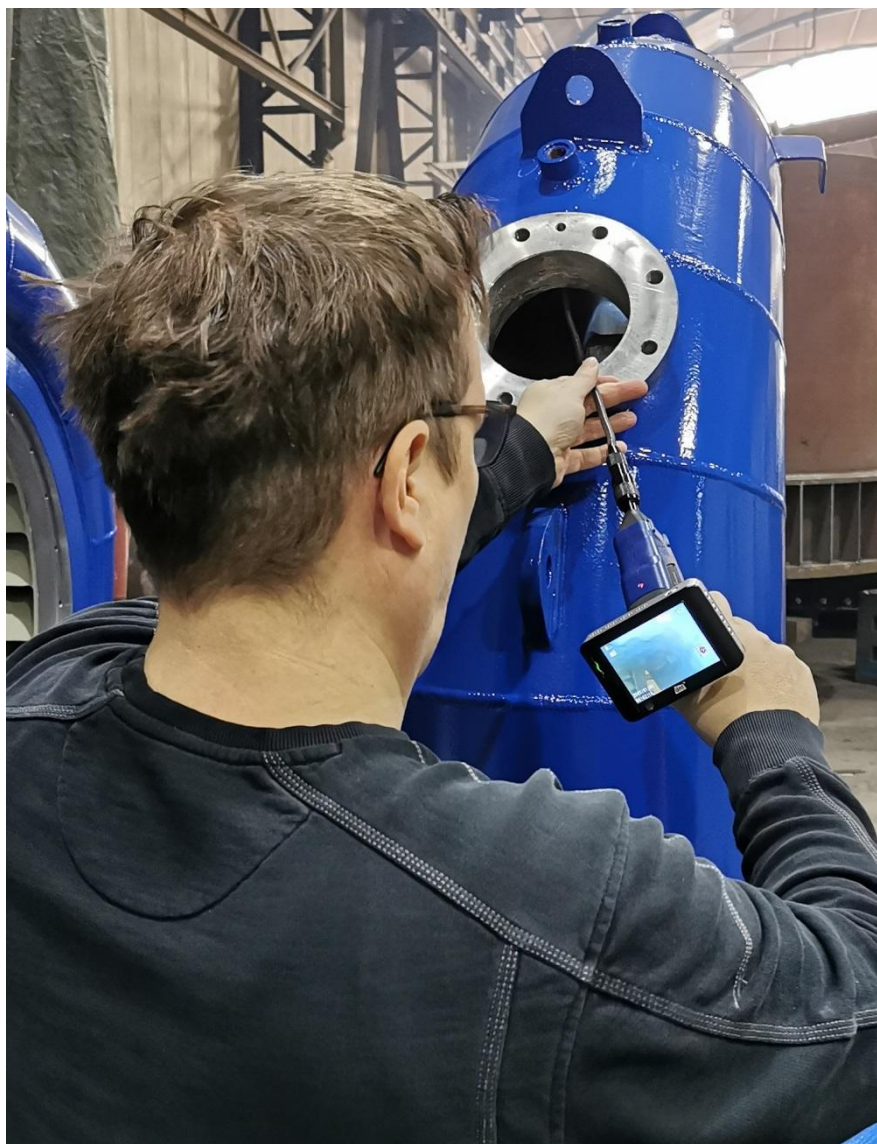
Slika 6. Indirektno vizualno ispitivanje
