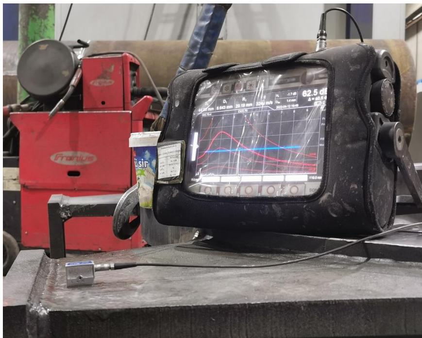
Slika 58. Ultrazvučno ispitivanje zavarenoj spoja „stope“
