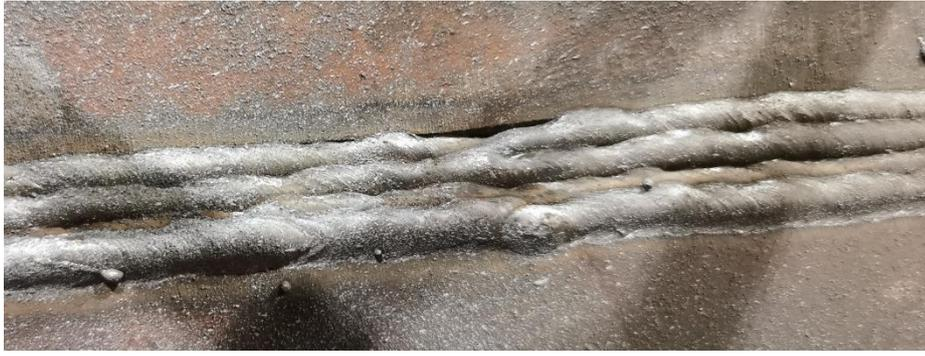
Slika 63. Vizualna greška: nedovoljno ispunjen presjek pripreme zavarenog spoja
