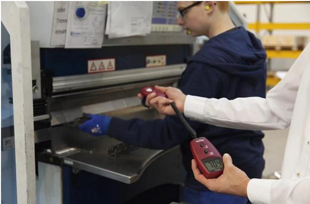
Slika 4. Mjerenje osvjjetljenja fotometrom [11]
