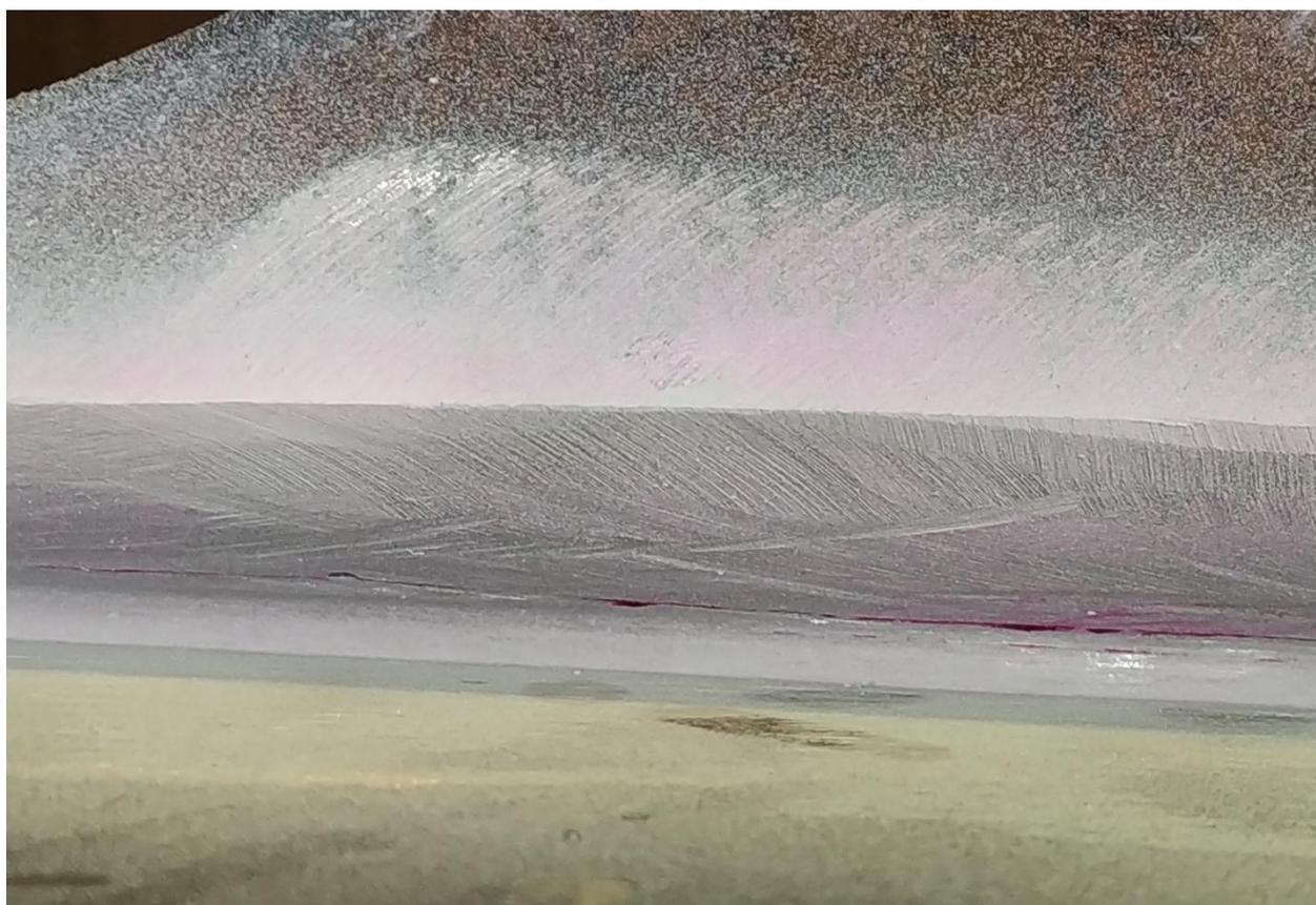
Slika 45. Indikacija prilikom ispitivanja penetrantskom kontrolom
