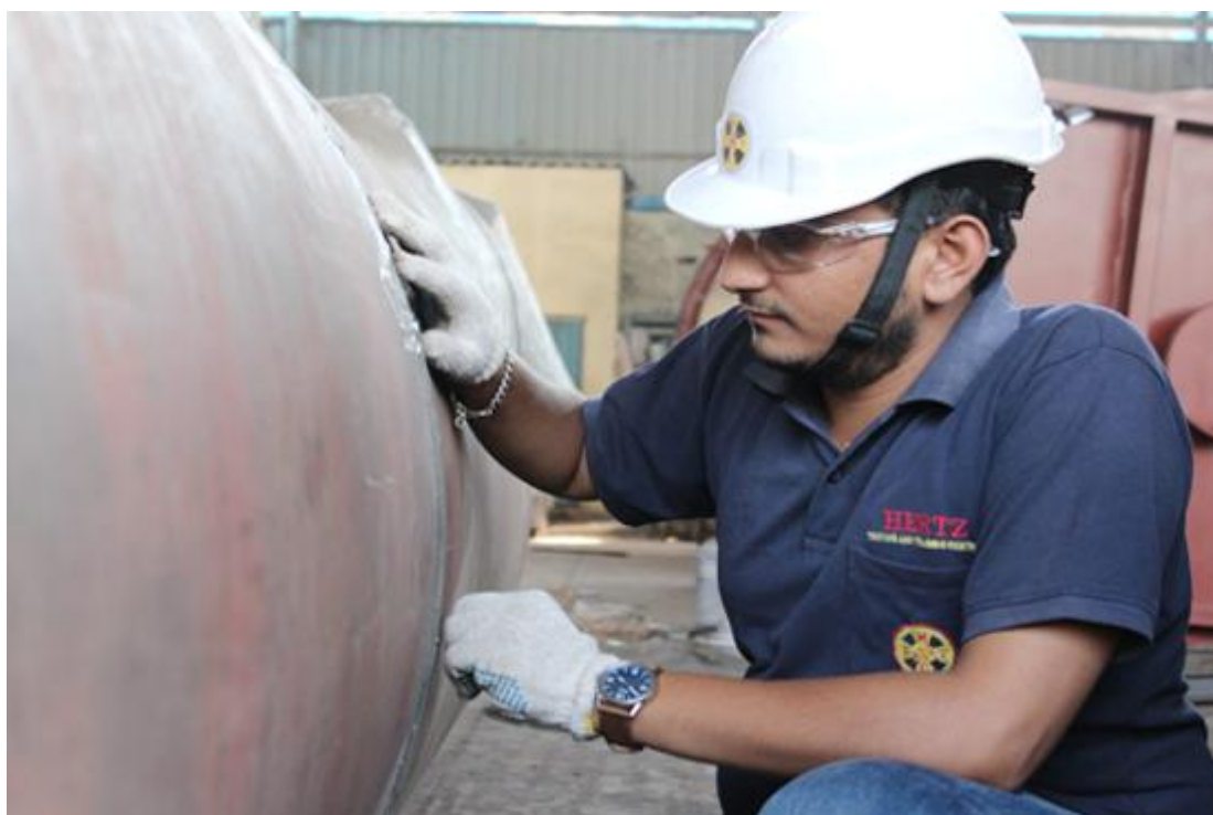
Slika 5. Direktno vizualno ispitivanje [12]
