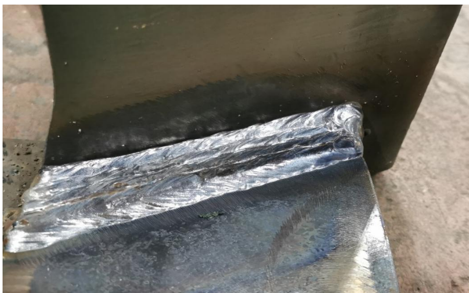
Slika 47. Vizualna kontrola lica zavara jednog od osam spojeva
