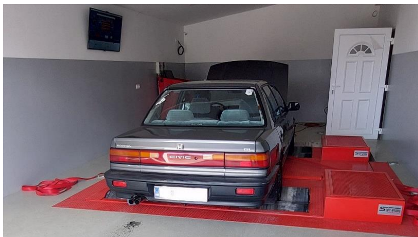
Slika 25: Automobil na ispitnim valjcima
