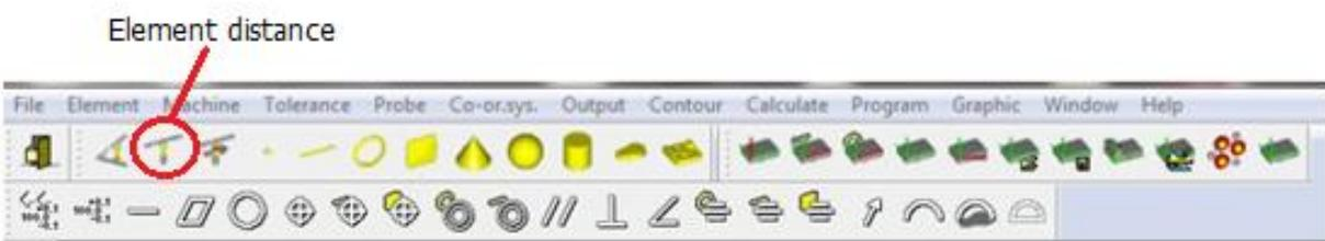
Slika 49. Ikona za mjerjenje udaljenosti
