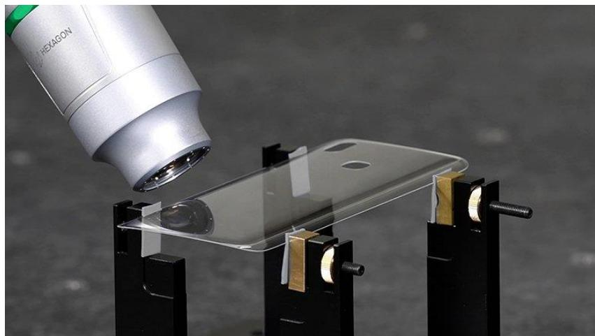
Slika 16. Beskontaktni senzor kromastog bijelog svjetla [13]
