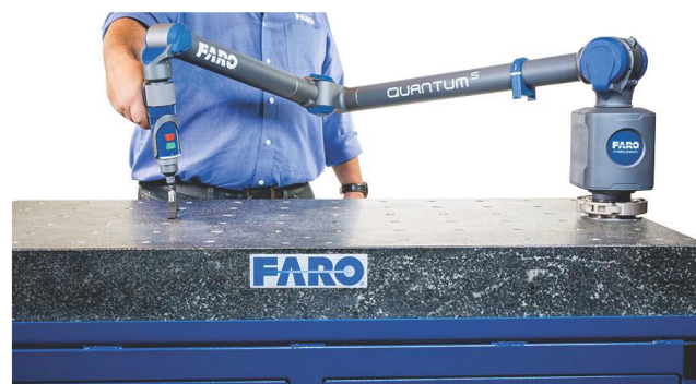
Slika 26. Kompenzacija sonde (kompenzacija rupe)
