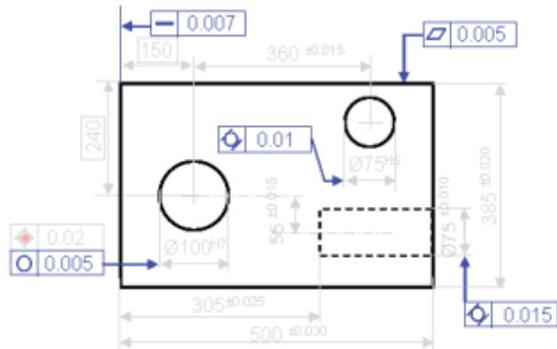
Slika 31. ISO 10360-2 "P"- prikaz kotiranja na nacrtu
