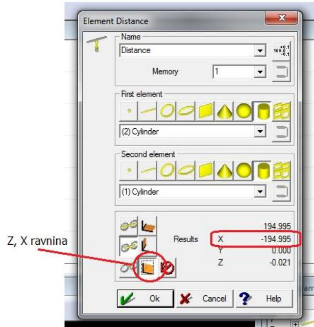
Slika 50. Određivanje udaljenosti
