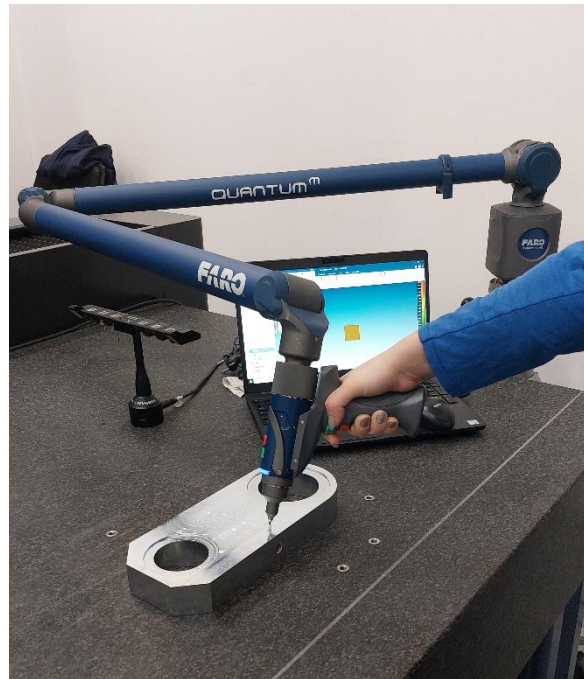
Slika 60. Postavljanje Faro 3D mjerne ruke i mjernog komada
