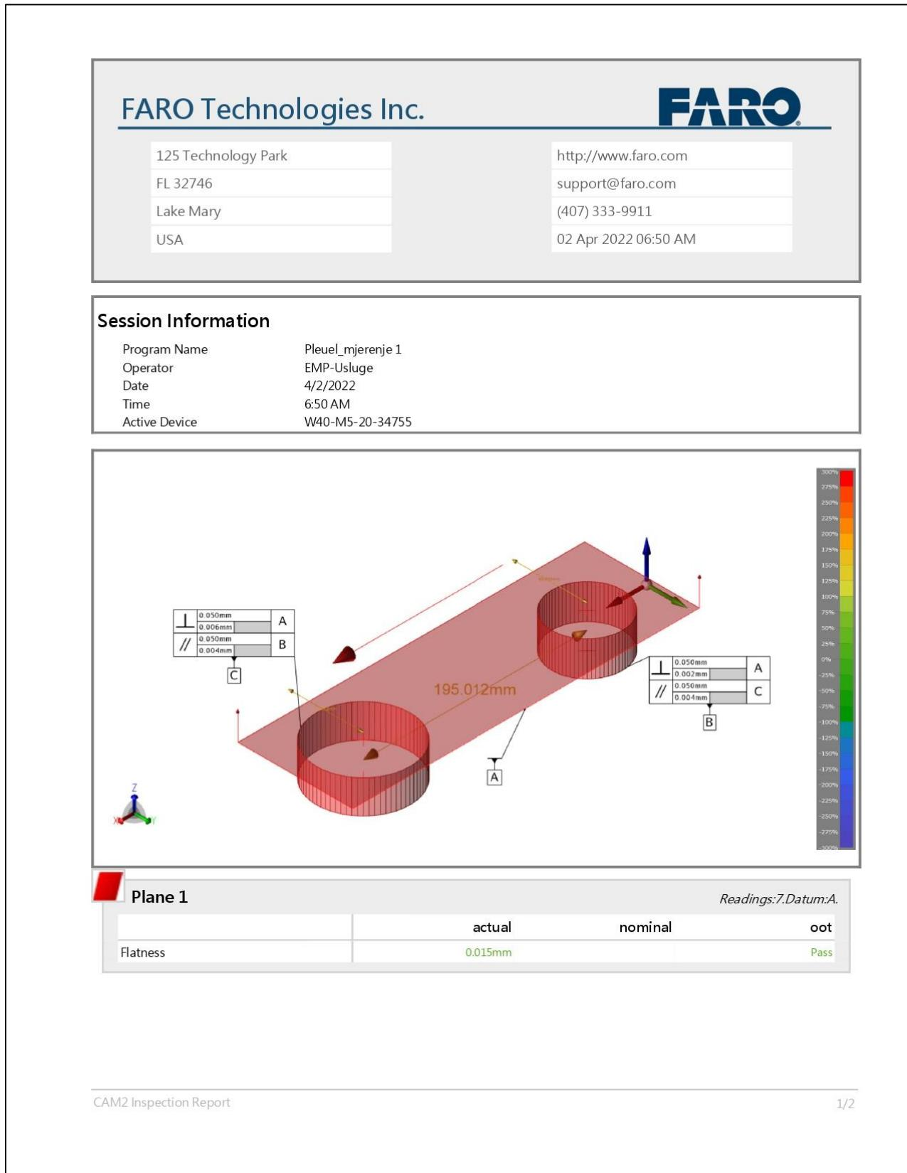
Slika 67.1. Predodžba mjernog izvješća Faro CAM 2 2019.
