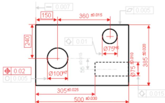
Slika 30. ISO 10360-2 "E"- prikaz kotiranja na nacrtu
