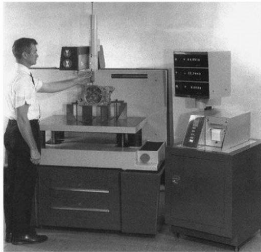
Slika 12. Ručno pomicanje probe
