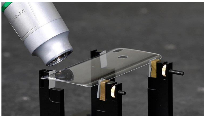
Slika 16. Beskontaktni senzor kromastog bijelog svijetla [13]
