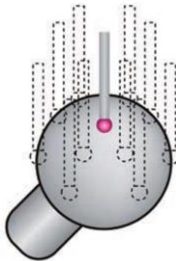
Slika 29. Prikaz mjerenja pogrešaka volumetrijskog sondiranja P
