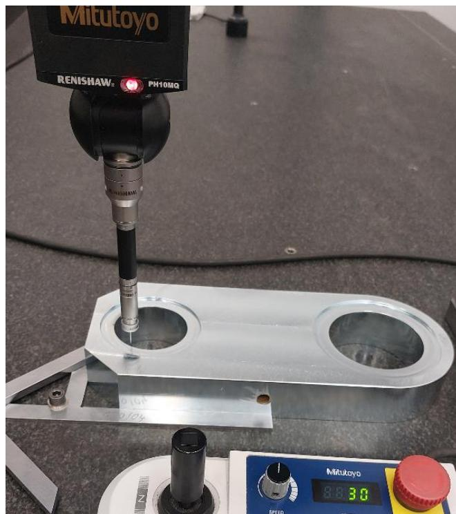
Slika 44. Postavljanje mjernog komada na trokoordinatni mjerni stroj
