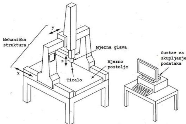
Slika 3. Glavni dijelovi koordinatnih mjernih uređaja [8]
