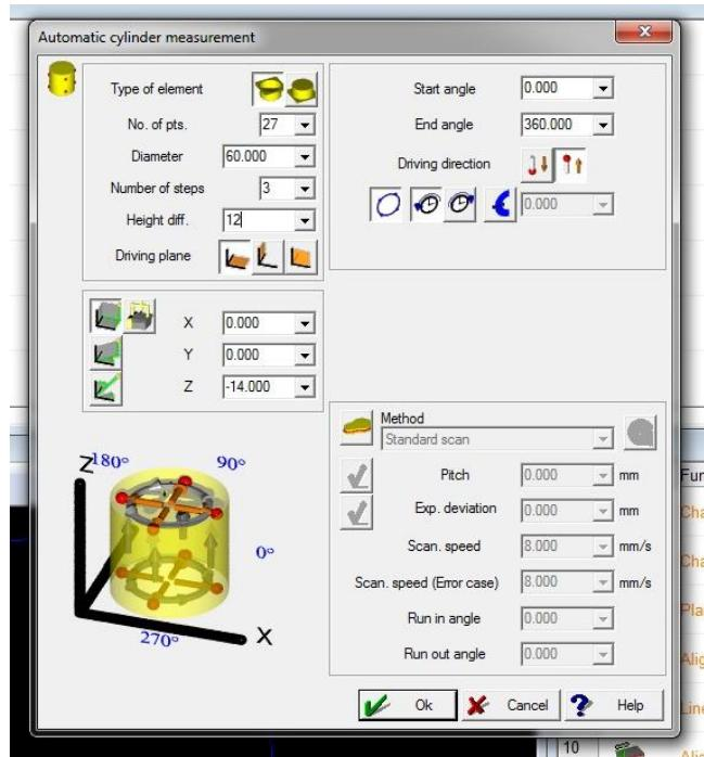
Slika 46. Postavke za automatsko mjerjenje valjka
