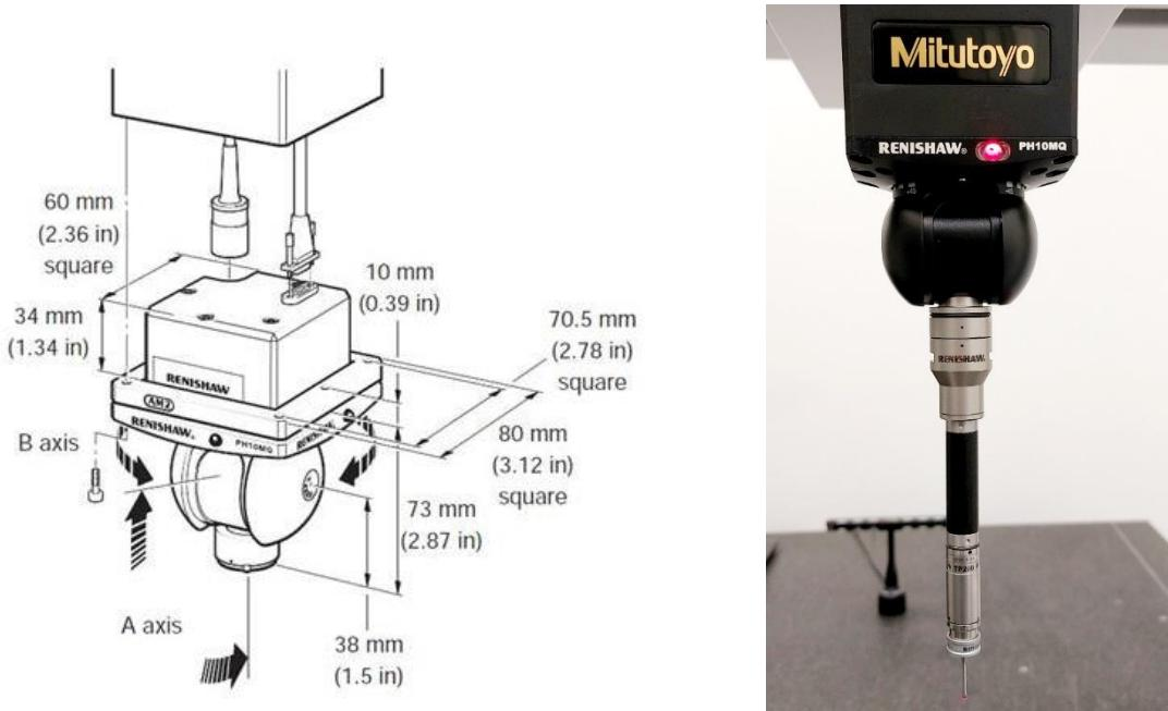
Slika 33. Dimenziije PH10MQ mjerne sonde
