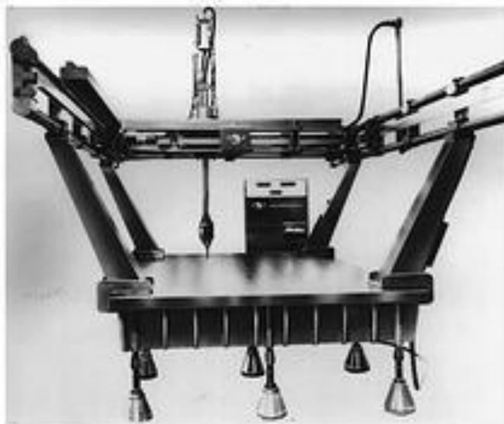
Slika 2. Prototip DEA CMM mjernog uređaja [6]
