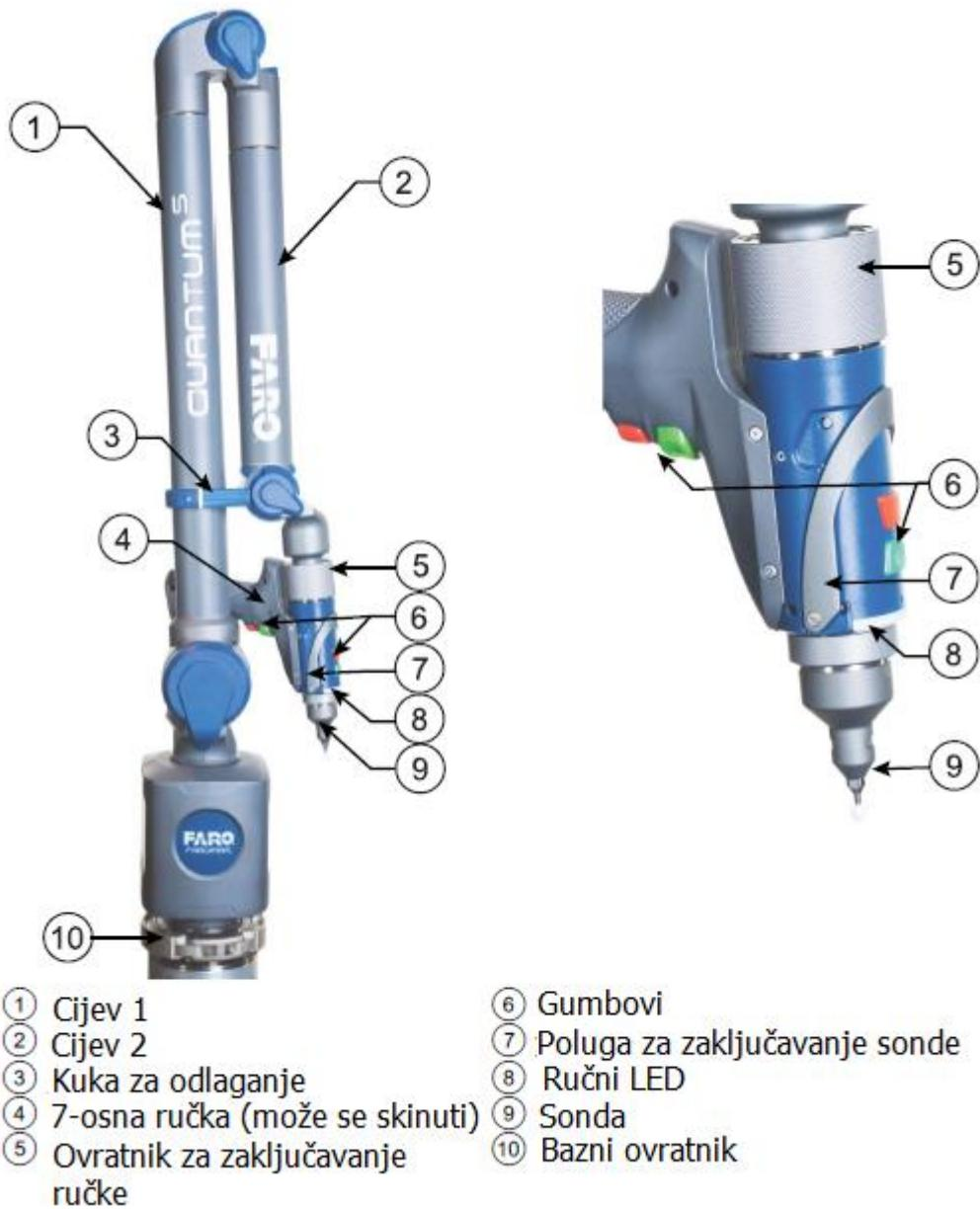
Slika 22. Ključne komponente 7-osne Faro mjerne ruke [18]
