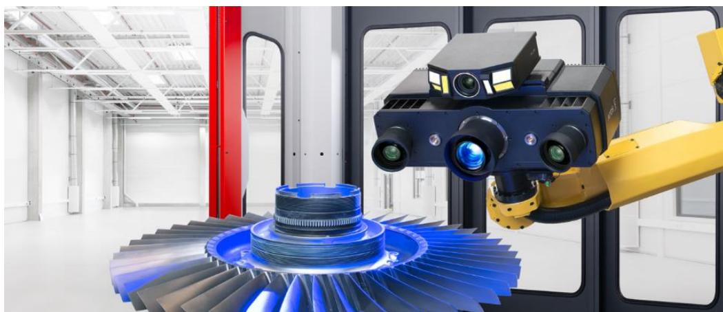
Slika 17. Primjer beskontaktnog senzora plavog svijetla [14]
