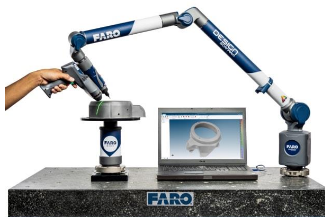
Slika 21. Primjer 3D mjerne ruke
