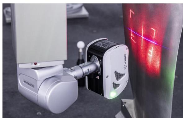
Slika 20. Primjer senzora s laserom
