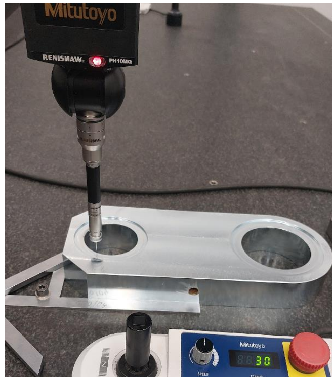
Slika 44. Postavljanje mjernog komada na trokoordinatni mjerni stroj
