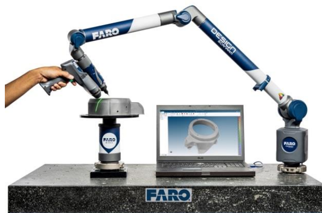
Slika 21. Primjer 3D mjerne ruke
