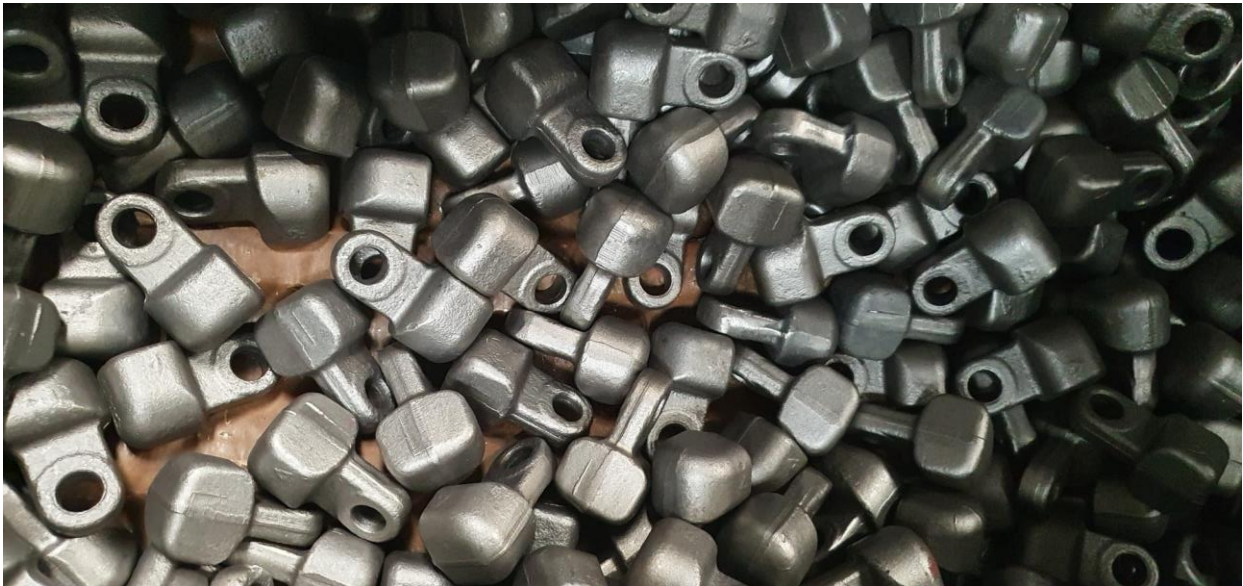
Slika 6 Dijelovi proizvedeni kovanjem u ukovnju
