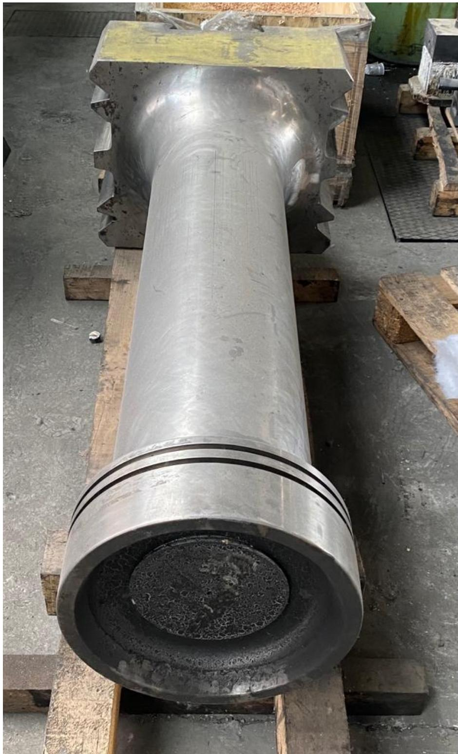
*Slika 15 Pneumatski bat*
