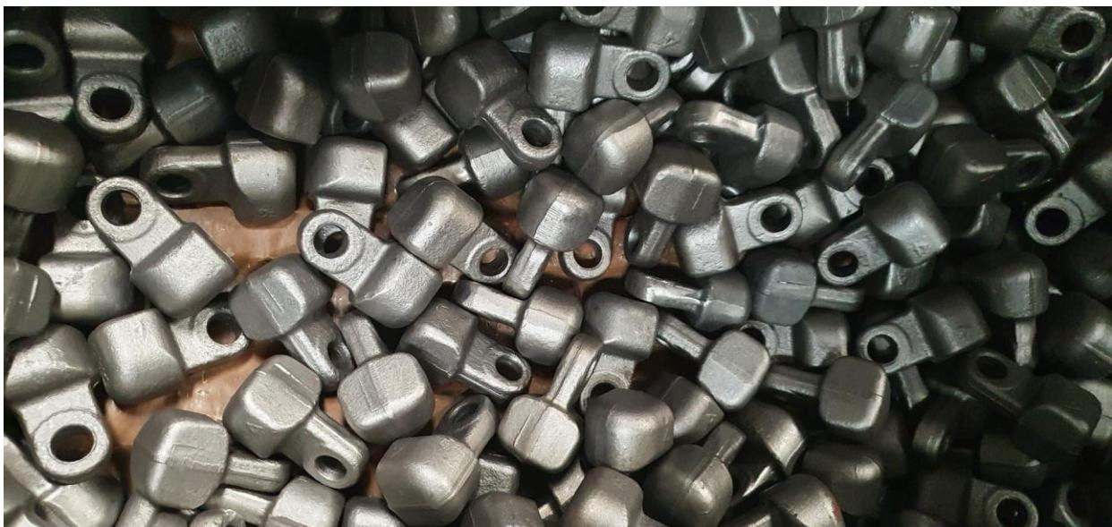
*Slika 6 Dijelovi proizvedeni kovanjem u ukovnju*
