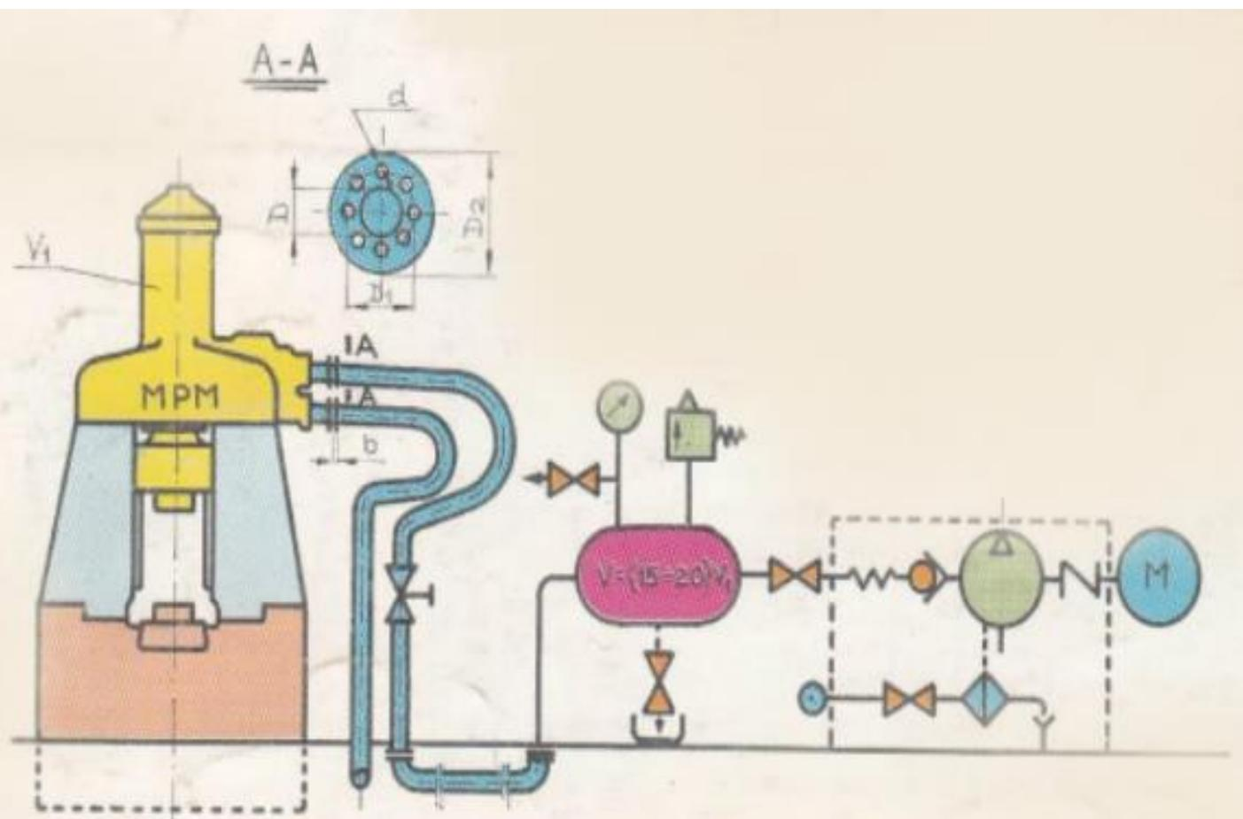
Slika 16 Dijagram spajanja čekića na dovod zraka:  $V_1$  = volumen zraka u cilindru,  $D$  = Visina baze prirubnice,  $D_1$  = udaljenost dva simetrična provrta na prirubnici,  $D_2$  = udaljenost dva simetrična provrta na prirubnici,  $d$  = promjer provrta na prirubnici,  $b$  = visina baze prirubnice;
