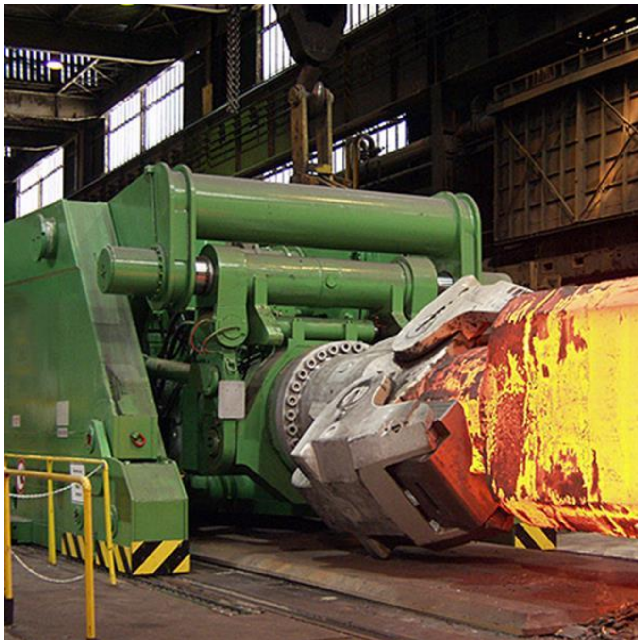
Slika 3 Manipulator za kovanje [4]
