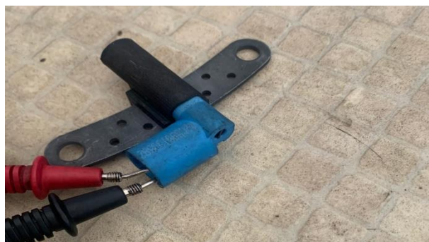
Slika27. Prikaz mjerenja otpora senzora. Izvor [20].
