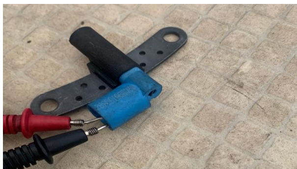
Slika27. Prikaz mjerenja otpora senzora. Izvor [20].
