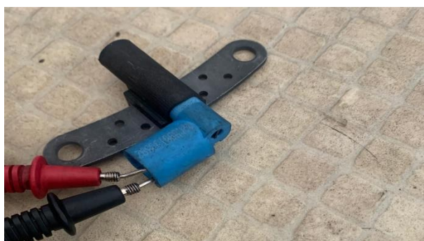
Slika27. Prikaz mjerenja otpora senzora. Izvor [20].
