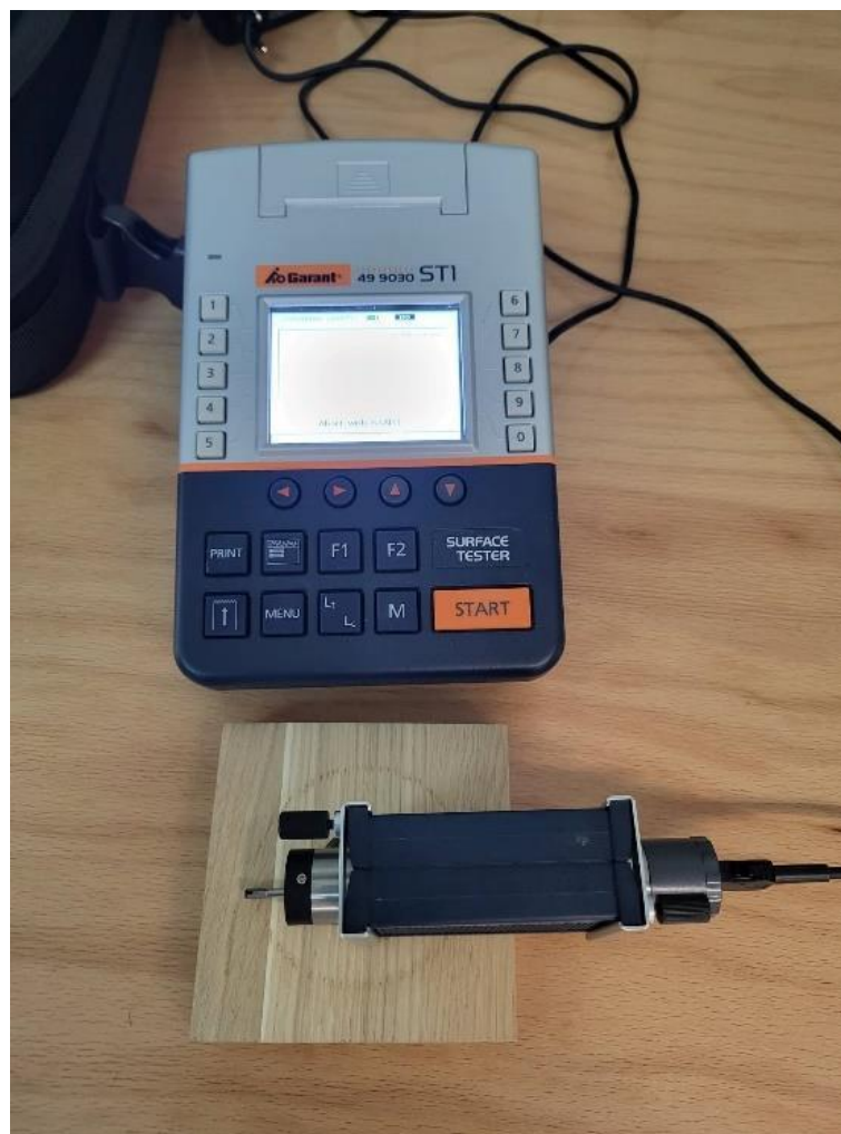
Slika 17. Prikaz ispitivanja hrapavosti površine [1]
