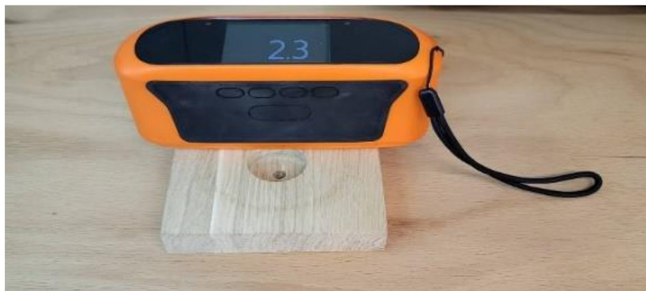
Slika 18. Prikaz mjerenja sjajnosti površine [1]
