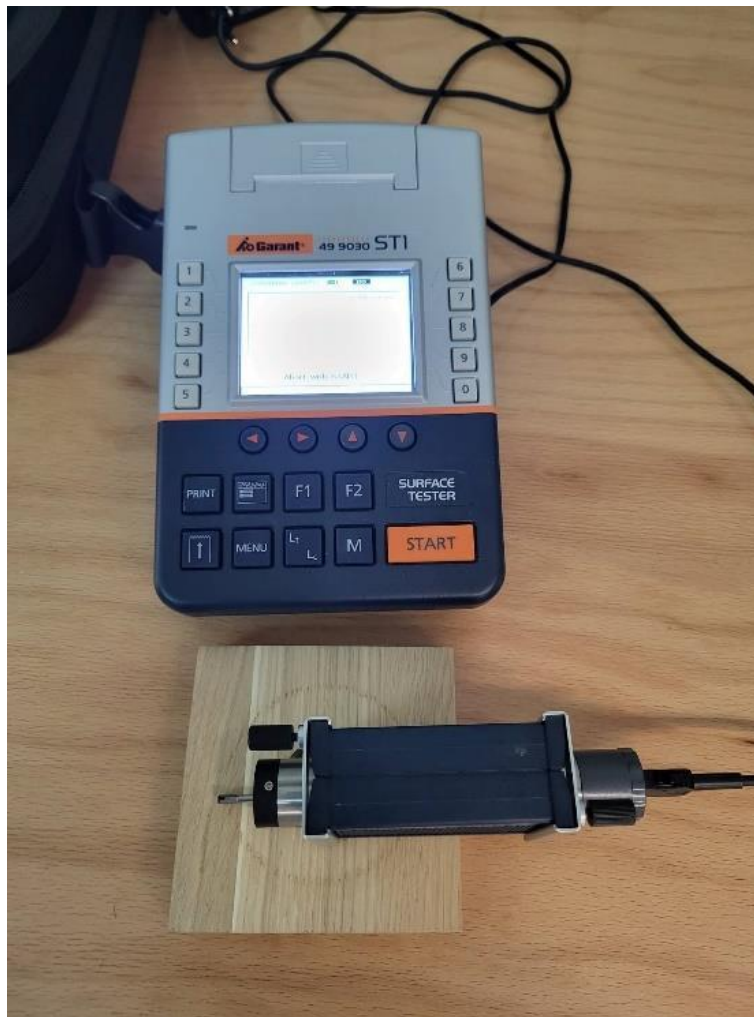
Slika 17. Prikaz ispitivanja hrapavosti površine [1]
