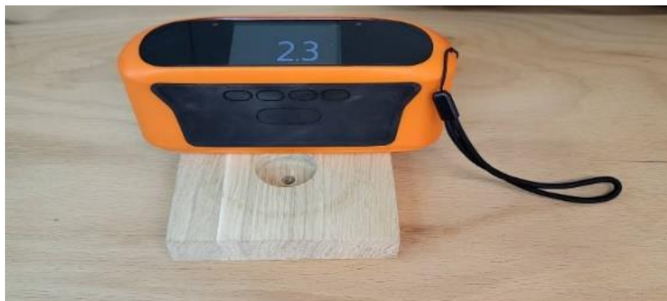
Slika 18. Prikaz mjerenja sjajnosti površine [1]
