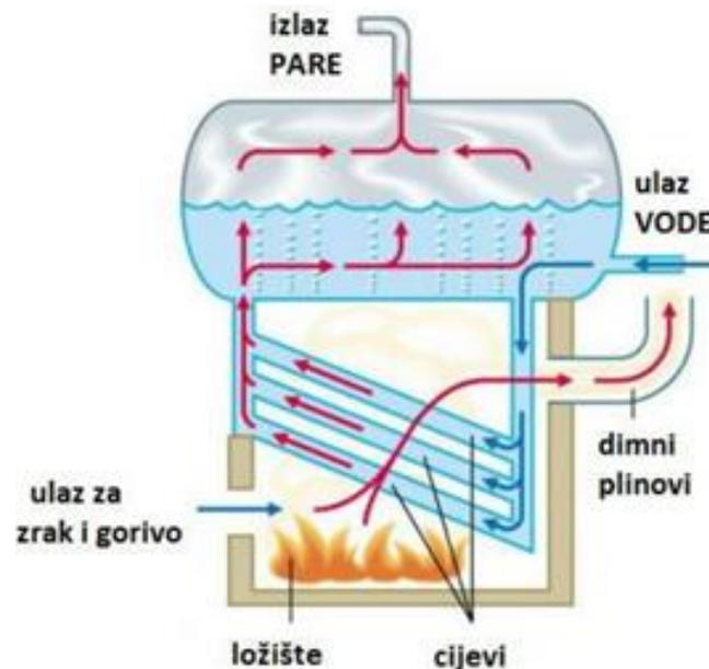
Slika 9. Vodocjevni kotao s uzdužno postavljenim bubnjem
